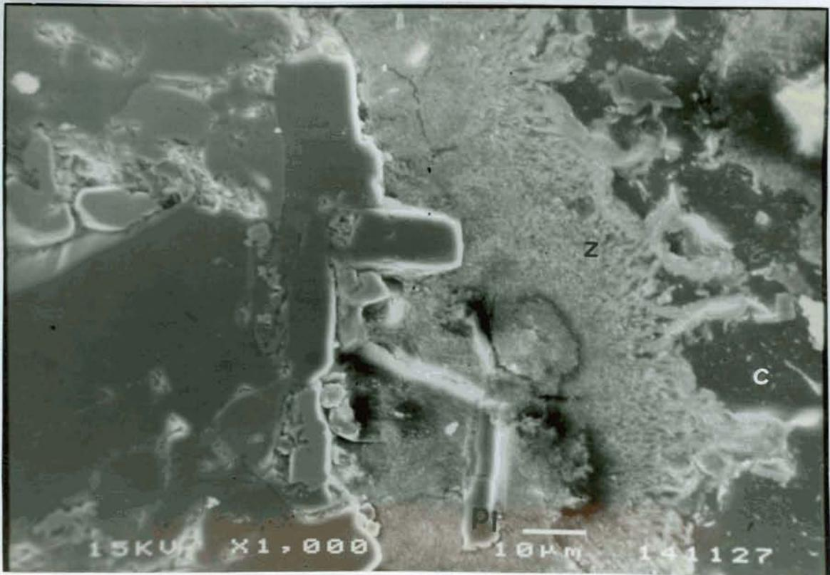
Fig. 5.12 Contato da vesícula (a direita) com a matriz da rocha. Um cristal de plagioclásio é englobado pela camada de zeolita mais externa da vesícula. c = calcita; z = zeolita; pl = plagioclásio MEV, 1.000x, (elétrons secundários).
