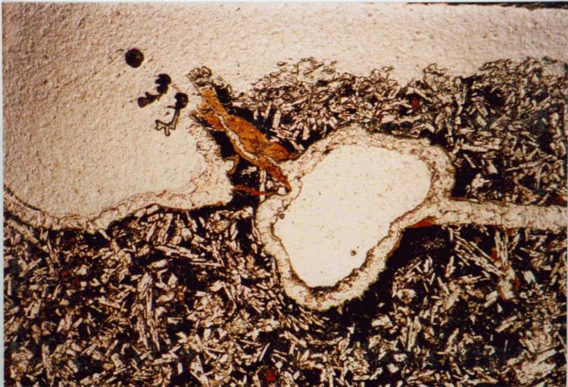
Fig.5.8 Vesículas interligadas por fratura preenchida também por zeolita. Mópt.LN.40x.
