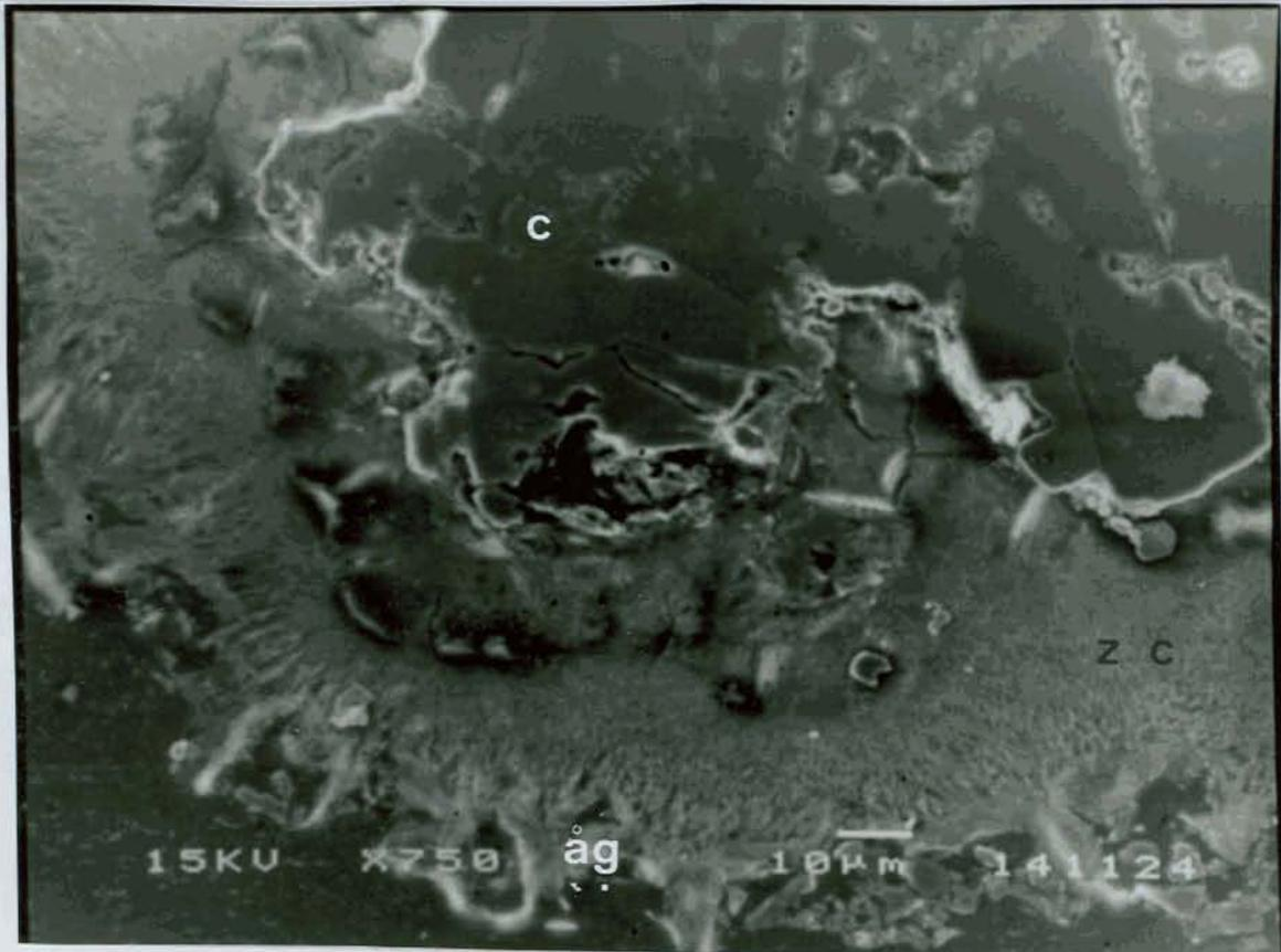
Fig. 5.10 Vesícula preenchida por cristais de calcita (c) no centro, zeolitas + pequenos cristais de calcita (z+c) na camada externa e argilominerais (ag) na borda. MEV, 750x (eletrons secundários).
