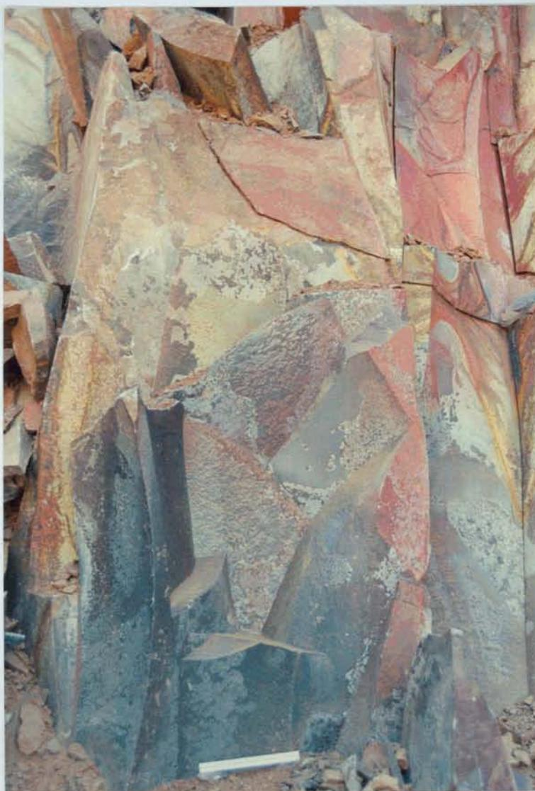
Fig. 3.7 Aspecto do fraturamento no entablamento, caracterizado por megacolumnas subdivididas em columnas menores.
