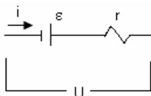
Figura 9: Gerador elétrico
