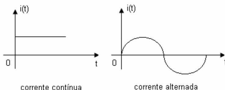
Figura 3: Corrente contínua e alternada
