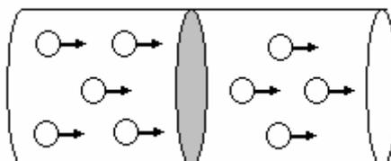
Figura 1: Corrente elétrica em condutor cilíndrico.
