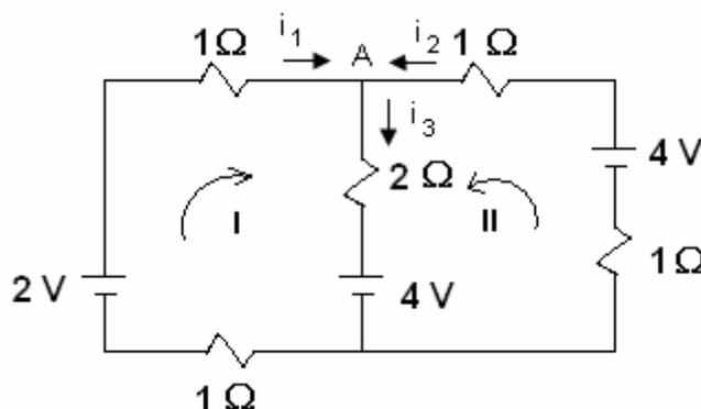
Figura 15: Circuito de duas malhas com especificação dos valores
