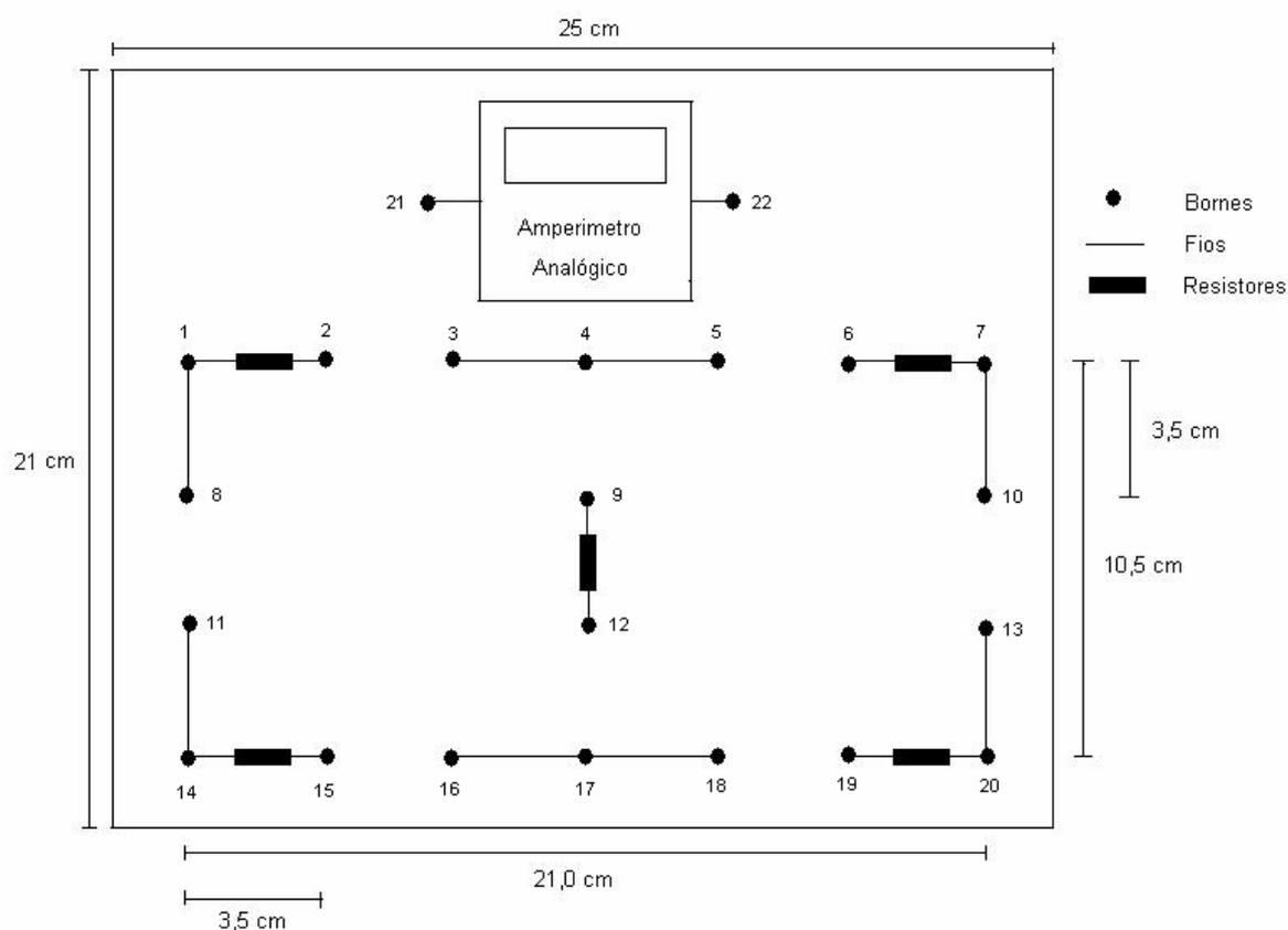
Figura 18: Planta do protótipo de circuito elétrico
