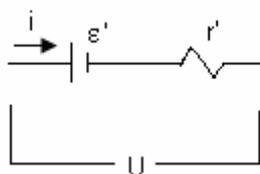
Figura 10: Receptor elétrico
