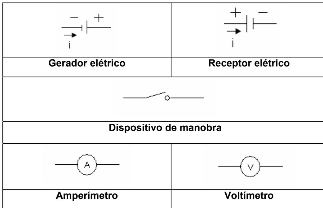
Figura 4: Elementos do circuito elétrico
