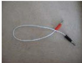
**fig 3** – Ponte de curto circuito
