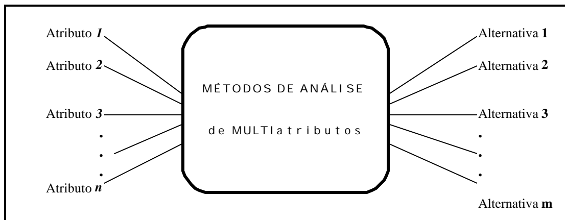
Figura 9 - Métodos de Análise de Multiatributo e suas Entradas e Saídas.
