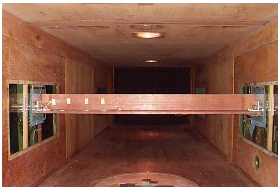
Figura 26: Foto do ensaio com perfil submetido a escoamento suave
