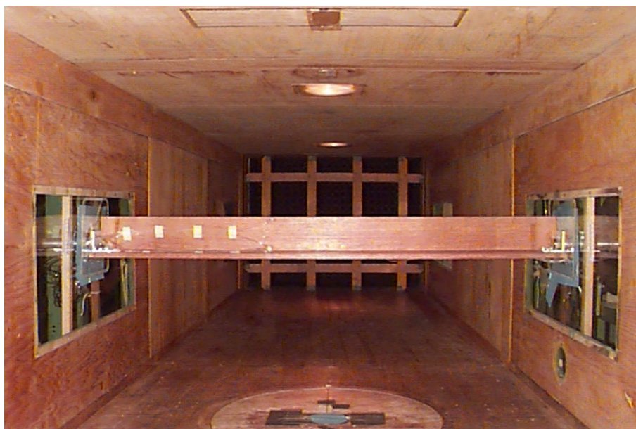
Figura 25: Foto do ensaio com perfil submetido a escoamento turbulento, com gerador de turbulência tipo grelha
