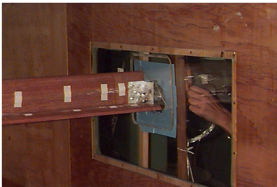
Figura C4: Detalhe da fixação do modelo no túnel.
