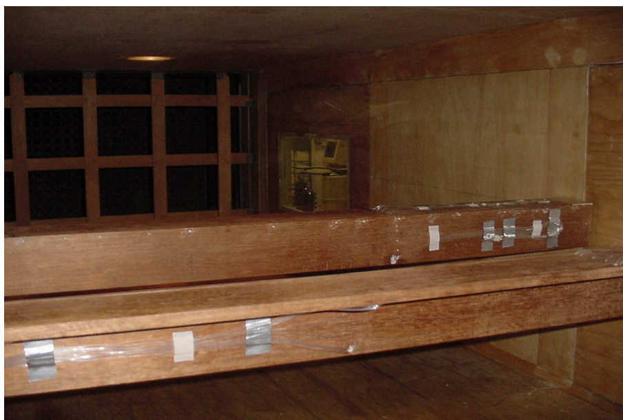
Figura C6: Segunda etapa de ensaios, modelos na posição 1, P1, com afastamento x/c= 4,43 e submetidos ao escoamento turbulento.
