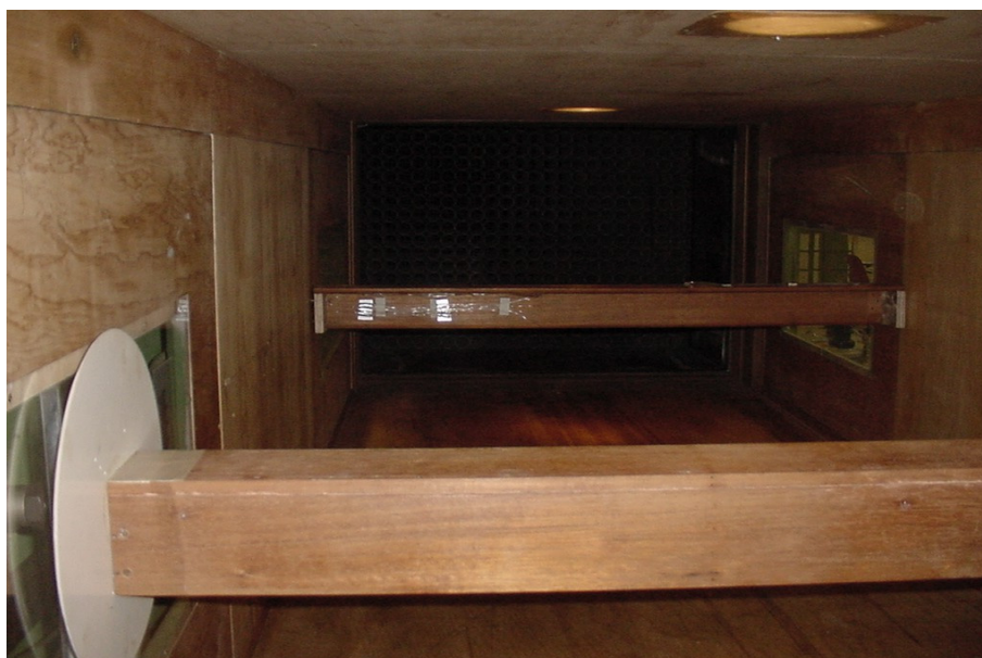
Figura C10: Modelos na posição 2, P2, com afastamento x/c=13,78 , submetidos ao escoamento suave.
