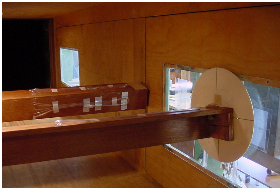
Figura C11: Modelos na posição 3, P3, com afastamento x/c=4,43 , submetidos ao escoamento suave.
