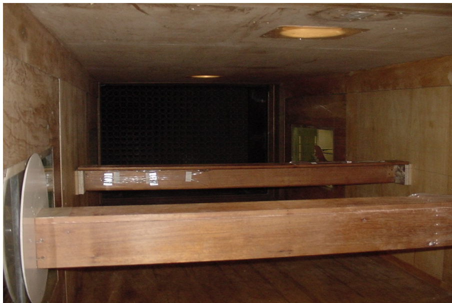
Figura C9: Modelos na posição 2, P2, com afastamento x/c=7,87 , submetidos ao escoamento suave.
