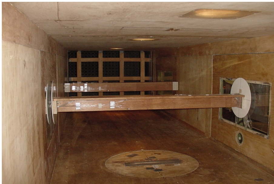
Figura C7: Modelos na posição 1, P1, com afastamento x/c=13,78 e submetidos ao escoamento turbulento.
