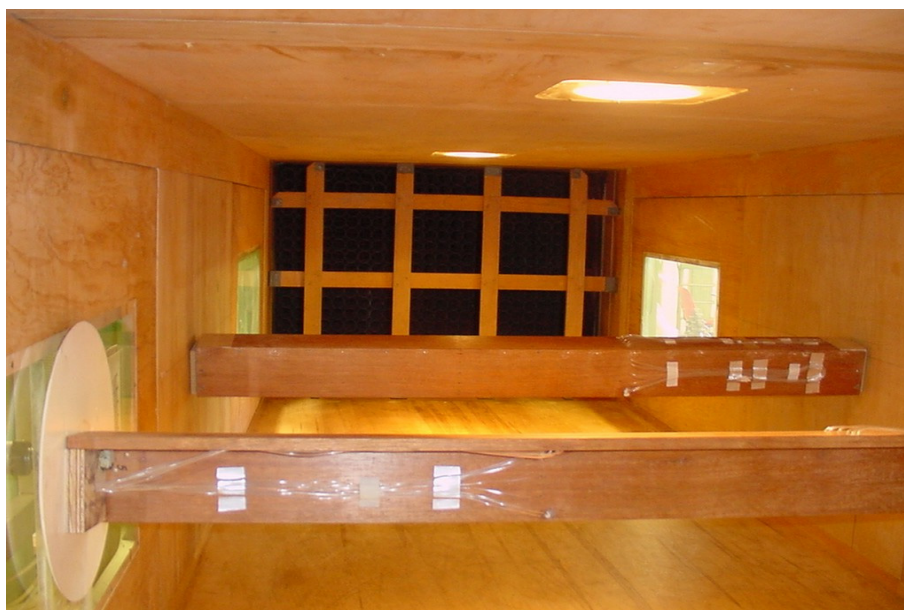
Figura C12: Modelos na posição 3, P3, com afastamento x/c=7,87 , submetidos ao escoamento turbulento.
