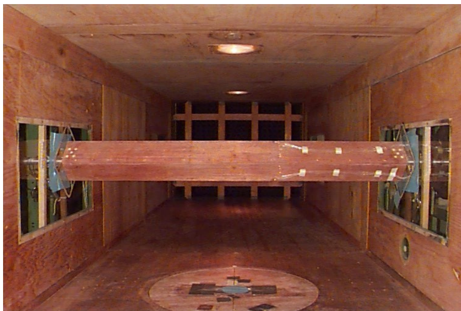
Figura C5: Modelo E2, submetido à escoamento turbulento, com ângulo de incidência do vento de -135^\circ .
