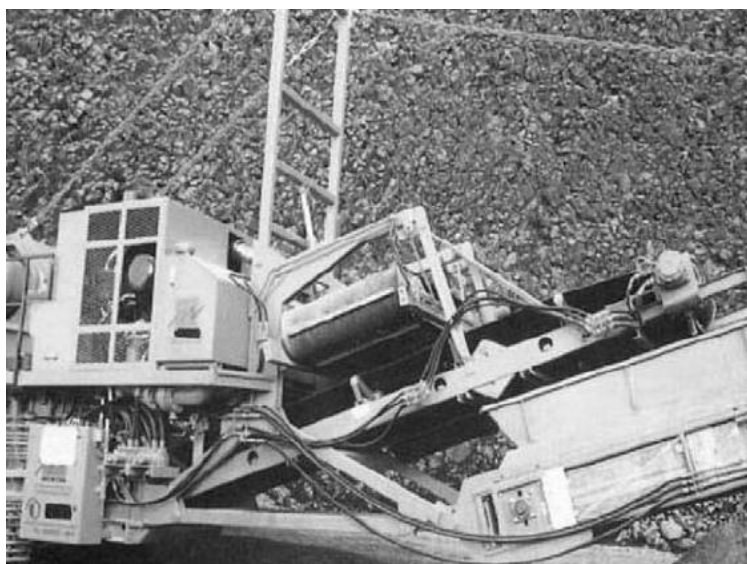
Figura 2.17: Separador magnético Steinert® de correia cruzada (SVOBODA, 2003).
