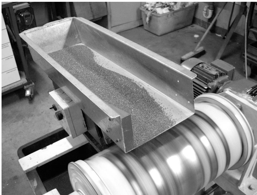
Figura 3.3: Separador de Rolo Magnético Permanente STEINERT® e calha vibratória.
