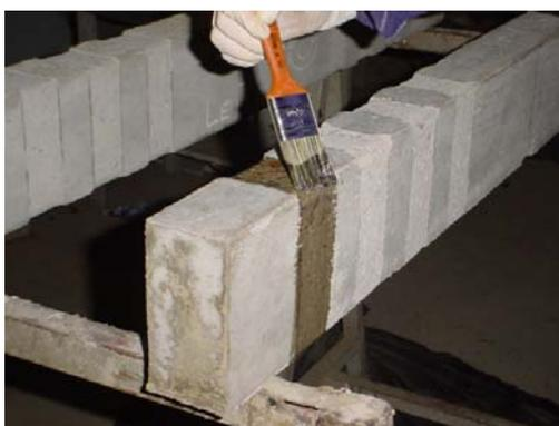
Figura 7.9: imprimação da superfície de concreto que receberá o reforço
