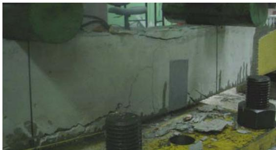
Figura 6.14: ruptura por fadiga da viga AB\_2
