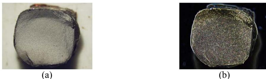
Figura 6.49: (a) barra de aço de viga VRC.F\_2; (b) imagem da barra no *Image J*
