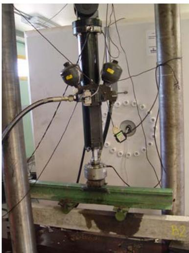
Figura 6.3: esquema de ensaio de fadiga do Grupo II.A
