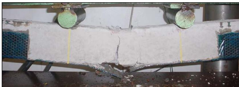
Figura 6.12: ruptura por fadiga da viga CB\_1
