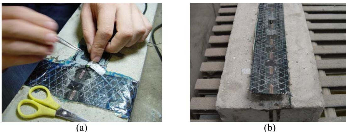
Figura 7.7: (a) detalhe do procedimento de colagem do *strain gauge*; (b) *strain gauges* no PRF de carbono
