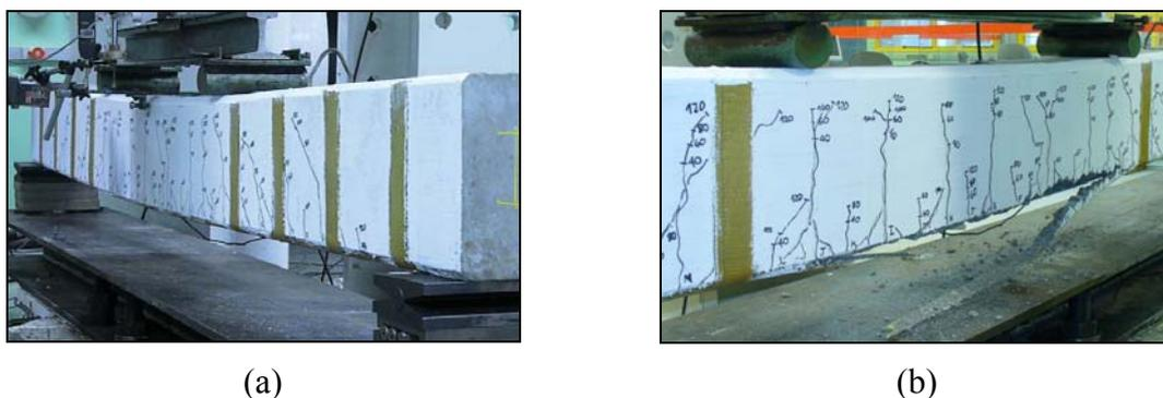
Figura 6.18: (a) viga VRA.E momentos antes do colapso; (b) detalhe do descolamento e fendilhamento do PRFA
