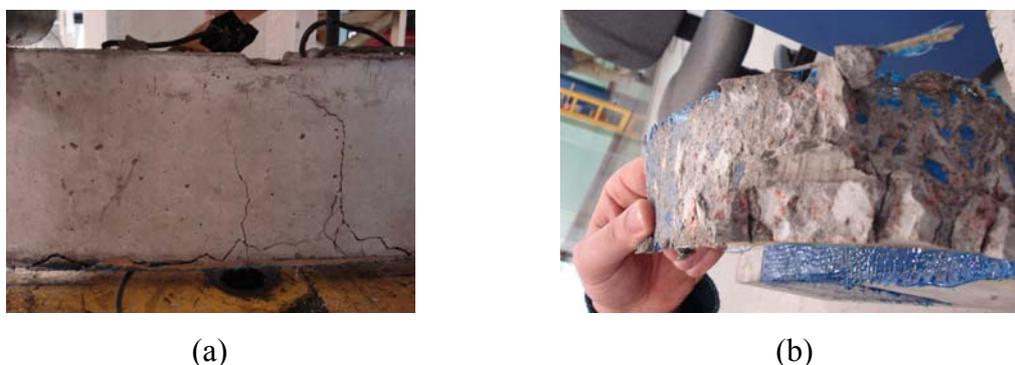
Figura 6.13: (a) ruptura por fadiga da viga VB\_1; (b) detalhe do descolamento do PRFV
