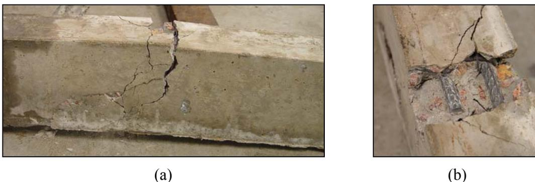
Figura 6.11: (a) TB\_1 – ruptura por fadiga; (b) detalhe da fratura das barras de aço
