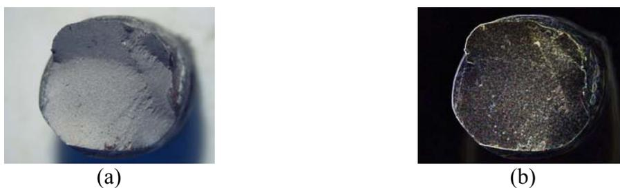
Figura 6.47: (a) barra de aço de viga VRA.F\_2; (b) imagem da barra no *Image J*
