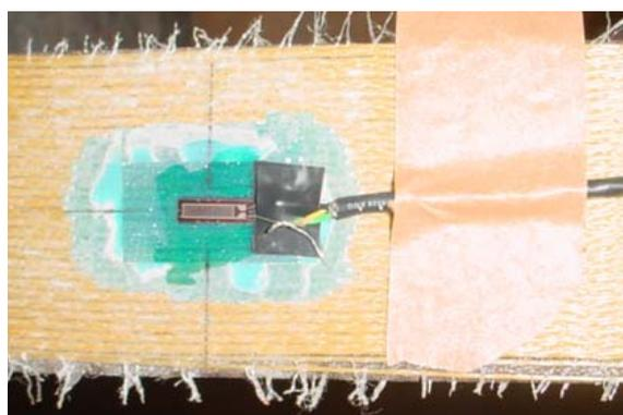
Figura 7.6: detalhe do *strain gauge* no reforço com PRFA
