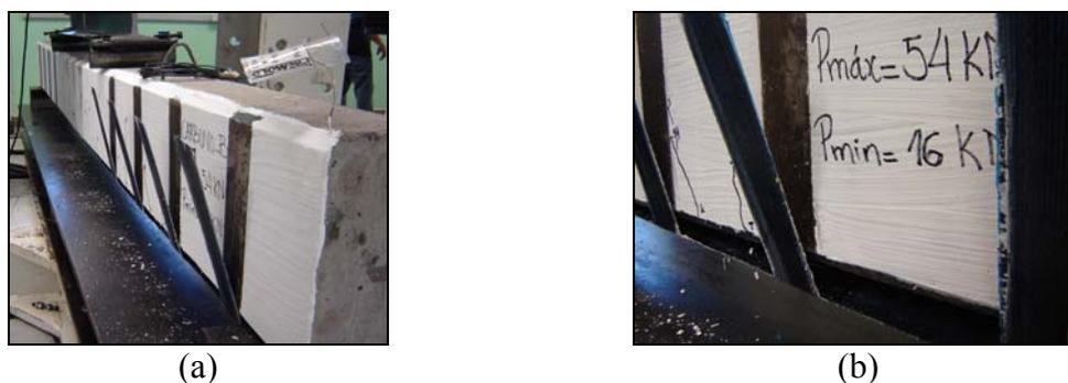
Figura 6.29: (a) viga VRC.F\_2 após o colapso; (b) detalhe do descolamento prematuro do PRFC
