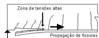
(d) Separação do concreto de cobrimento
