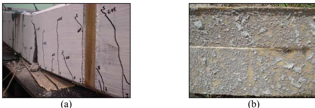
Figura 6.28: (a) viga VRA.F\_1 após o colapso; (b) detalhe da fina camada de concreto aderida ao PRFA
