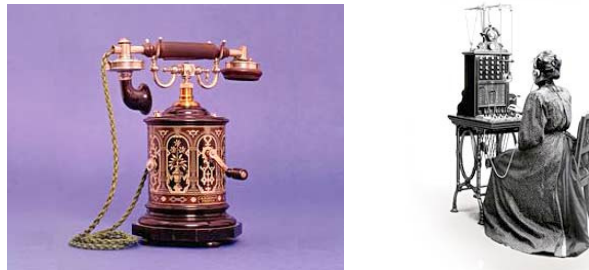
Figura 10: modelo para casas de 1893, em madeira, também com manivela para comunicação direta com telefonista (à esquerda); telefonista em terminal telefônico com capacidade para 25 linhas diferentes, em 1897 (à direita);
