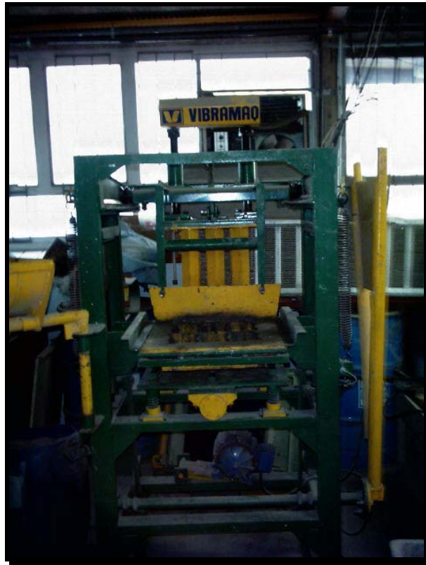
Figura 17 – Visão frontal da vibro-prensa
