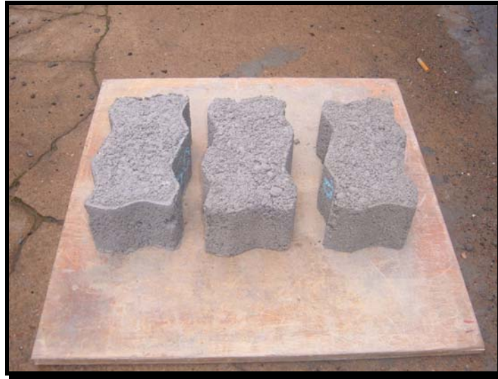
Figura 22 – Blocos com 50 %, 75 % e 100 % de agregado miúdo reciclado
