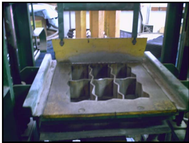
Figura 18 – Detalhe dos moldes na vibro-prensa
