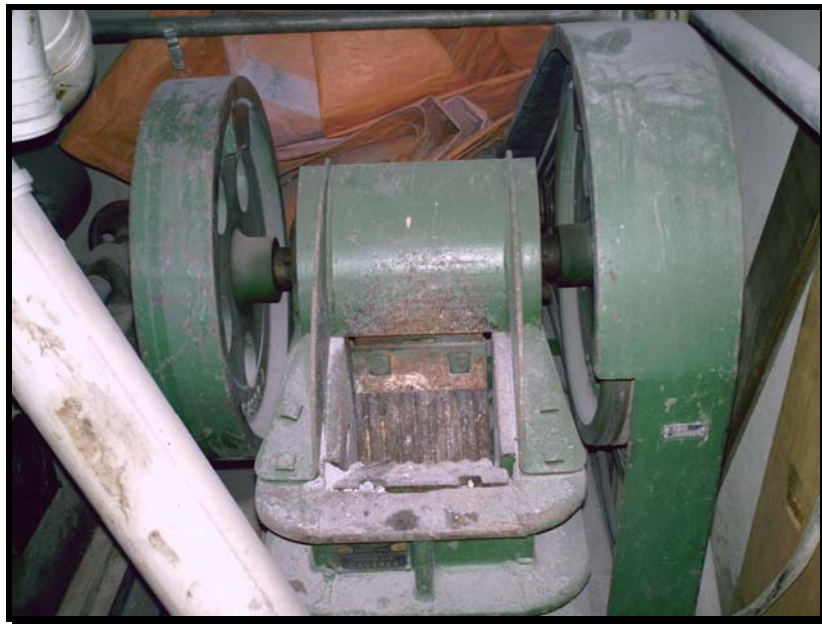
Figura 9 – Britador de mandíbula empregado para redução até um diâmetro máximo de 32 mm
