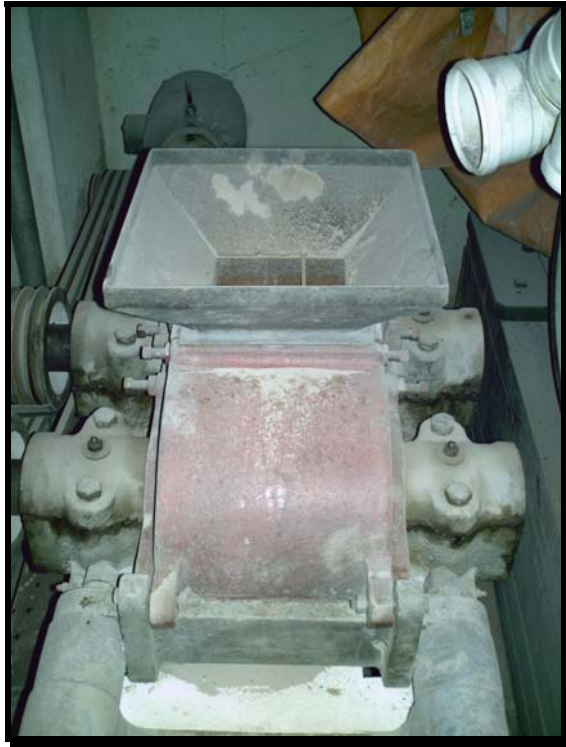
Figura 10 – Moinho rotativo empregado para obtenção de agregado miúdo reciclado
