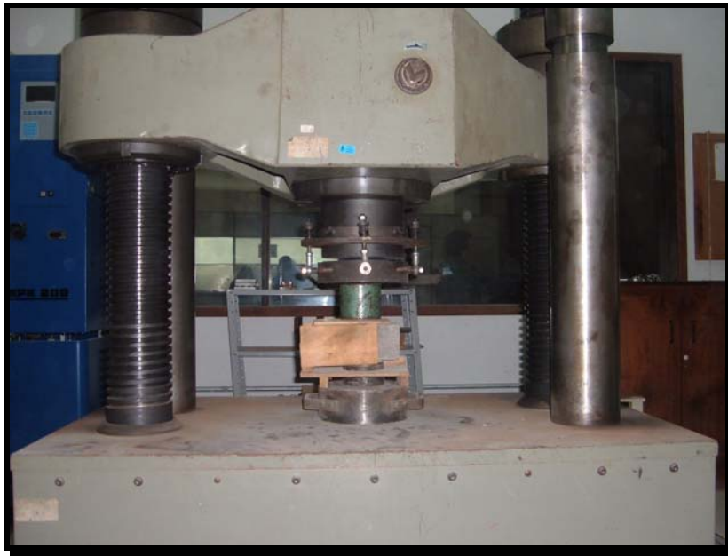
Figura 24 – Dispositivo de madeira empregado durante a execução do ensaio
