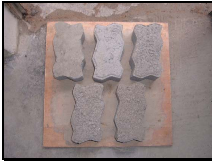
Figura 23 – Blocos com 0 %, 25 %, 50 %, 75 % e 100 % de agregado miúdo reciclado. Visualização de cima para baixo, da esquerda para a direita
