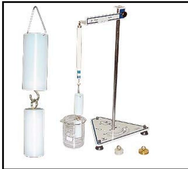
**Figura 4.18:** Equipamento denominado empuxômetro.
