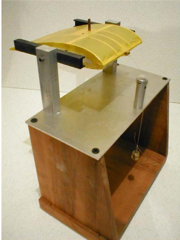
**Figura A2** – Dispositivo aerodinâmico para demonstrar a força de arraste
