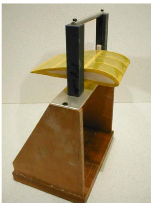
**Figura A1** – Dispositivo aerodinâmico para demonstrar a força de sustentação
