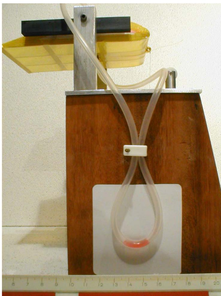
**Figura A4** – Protótipo para verificar a diferença de pressão existente entre a parte superior do aerofólio e a parte inferior. Imagem capturada quando o gerador de fluxo de ar está desligado.
