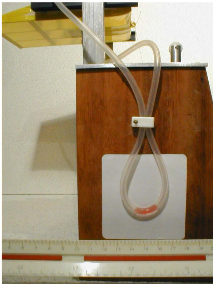
**Figura A5** – Protótipo para verificar a diferença de pressão existente entre a parte superior do aerofólio e a parte inferior. Imagem capturada quando o gerador de fluxo de ar está ligado
