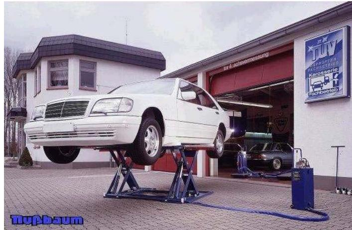
**Figura 4.13** – Representa um elevador hidráulico portátil utilizado para erguer automóveis.
