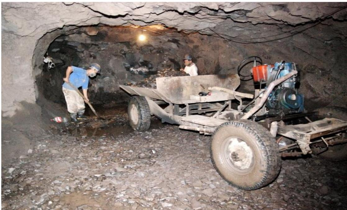
**Figura 10.** Transporte utilizado para limpeza das galerias e retirada dos geodos para o exterior da galeria.
