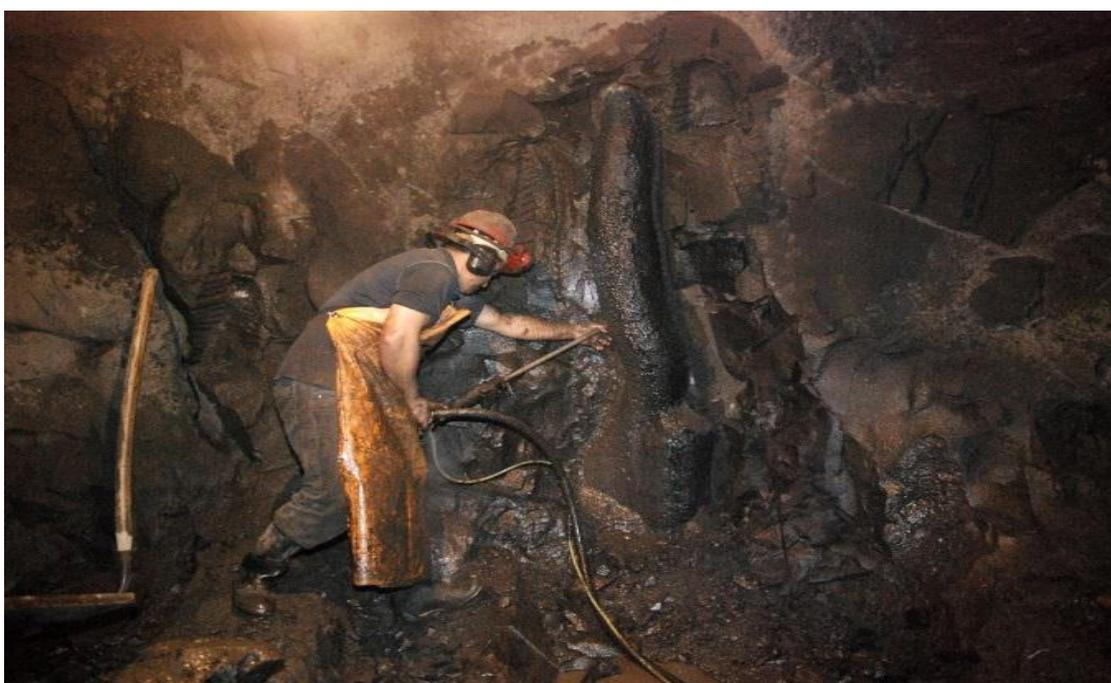
**Figura 9.** Perfuração da rocha à úmido associada ao uso de EPIs.
