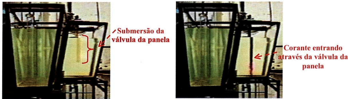
Figura 40. Fotos laterais do modelo físico mostrando em detalhe a) a submersão do jato de entrada do distribuidor (válvula longa da panela) e b) o jato de entrada com corante.
