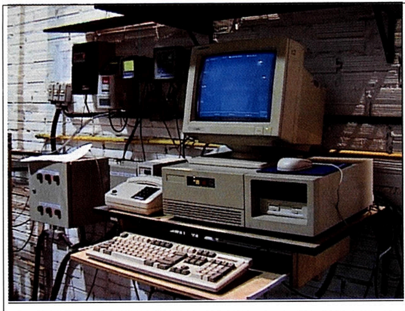
Figura 80. Micro-computador utilizado para armazenar os dados de condutividade
