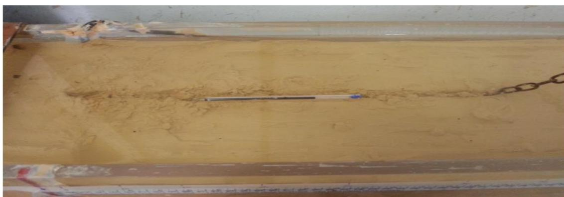
Figura 69 – Marca superficial da ruptura do solo provocado pelo deslocamento da amarra.
