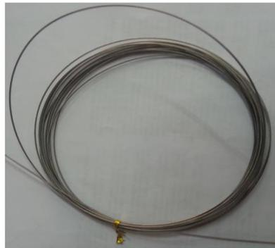
Figura 47 – Cabo de aço de inox, de 1mm de diâmetro, revestido de nylon.
