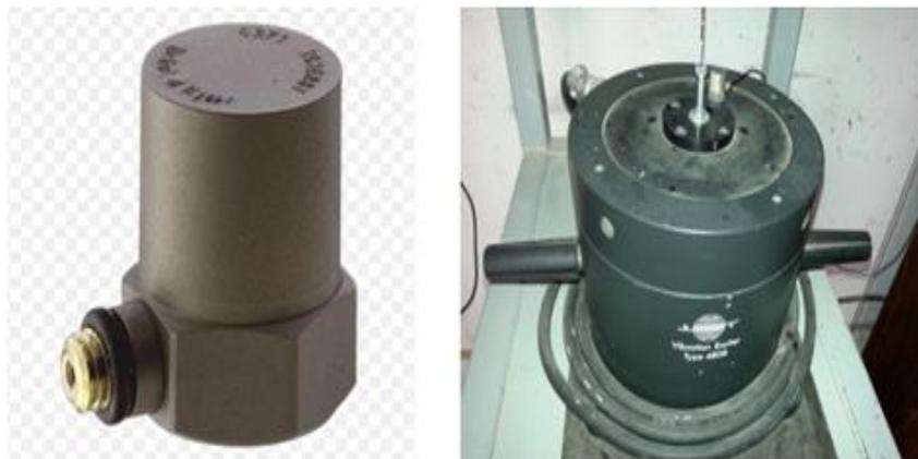
Figura 62 – Acelerômetro piezoelétrico e a sua instalação no excitador de vibração.
