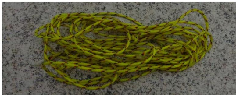
Figura 48 – Cabo Kevlar utilizado para fixar o moitão móvel (Rocha, 2014).
