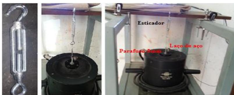
Figura 57 – Sistema de Aplicação do Carregamento Dinâmico.
