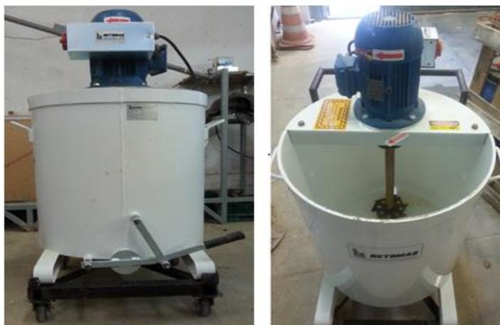
Figura 65 – Vistas lateral e superior do conjunto (misturador, bomba e carrinho).
