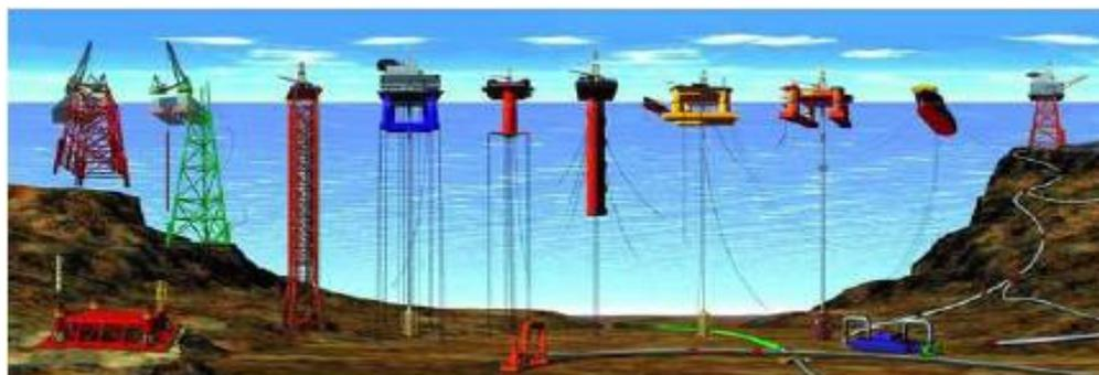
Figura 1 – Plataformas fixas e flutuantes localizadas em diferentes condições oceânicas (MARQUES,2010).
