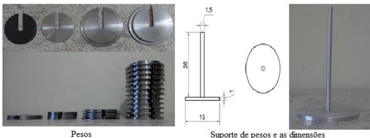
Figura 50 – Pesos utilizados para a realização dos ensaios (Rocha, 2014).
