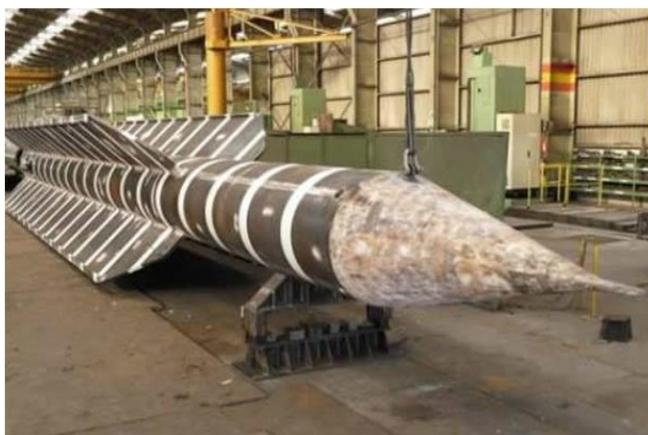
Figura 14 – Estaca torpedo.
