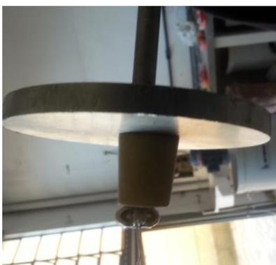
Figura 55 – Peça utilizada para prender a extremidade do cabo que passa pelo suporte de pesos.
