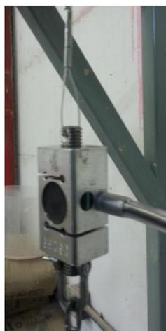
Figura 53 – Representação da célula de carga superior.
