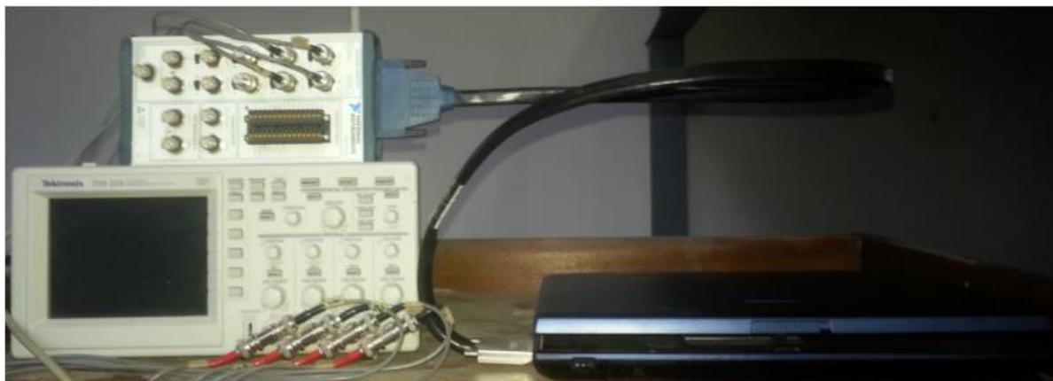
Figura 64 – Cabos NI SHC68.68EPM e NBC utilizados para aquisição de dados.
