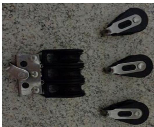
Figura 49 – Representação de 3 moitões fixos e 1 moitão triplo móvel (Rocha, 2014).
