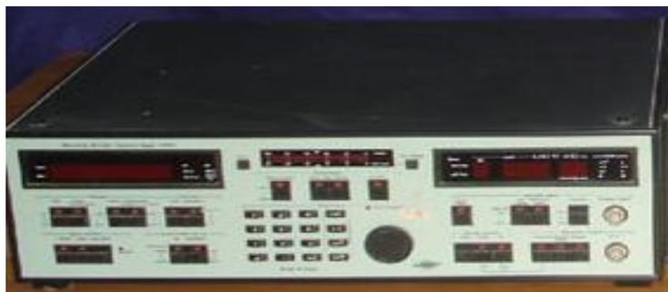
Figura 58 – Controlador de excitador de vibração.
