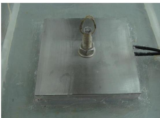
Figura 51 - Colagem da célula de carga inferior no fundo do tanque por meio de silicone.
