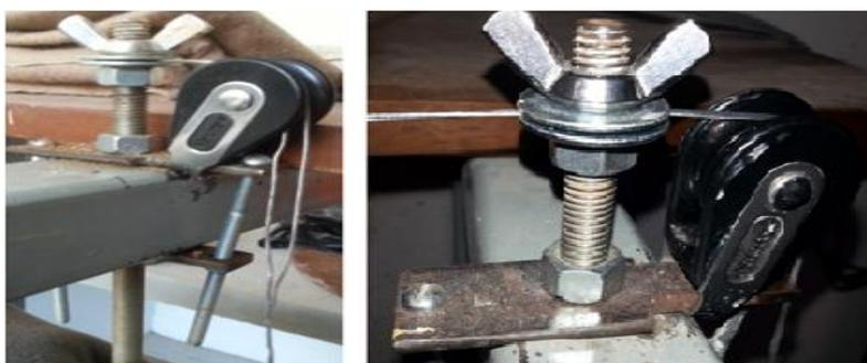
Figura 56 – Sistema de travamento do cabo de aço inox.
