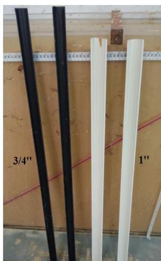
Figura 73 – Tubos de PVC utilizados nos primeiros ensaios para a retirada de amostras de solo ao longo de profundidade.
