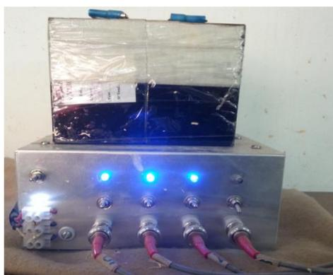
Figura 52 – Amplificador e 2 baterias de 12V cada.
