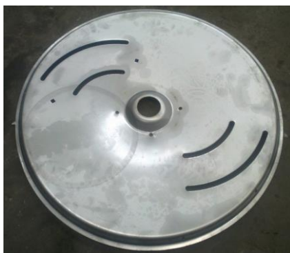
Figura 2 – Disco Distribuidor Fertilizantes fabricado em aço inoxidável AISI 304
