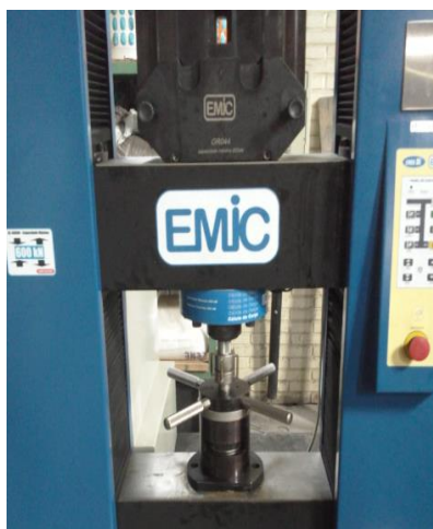
Figura 21 - Equipamento Emic DL60000, utilizado no ensaio de tração, anisotropia e ensaio Erichsen. Fonte: UFRGS
