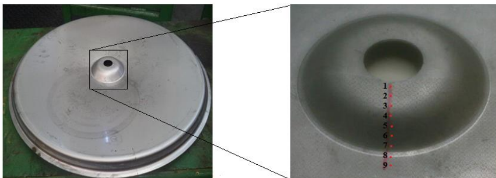
Figura 51 – Peça estampada mostrando a região de medição das deformações
