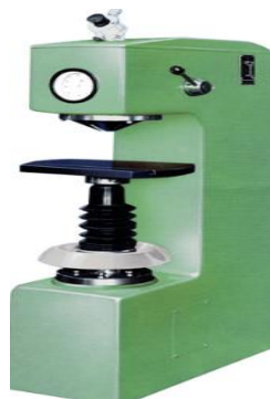
Figura 23 - Durômetro Microtest 737, utilizado para ensaio de dureza. Fonte: Stara
