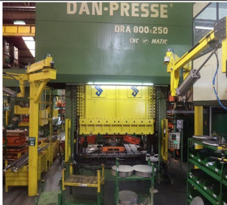
Figura 35 - Prensa Dan-Press 800T, utilizada na estampagem. Fonte: Stara
