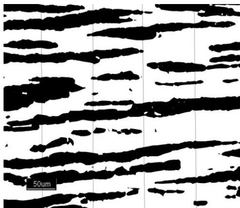
Figura 38 : Imagem segmentada para medição da espessura das lamelas de ferrita.
