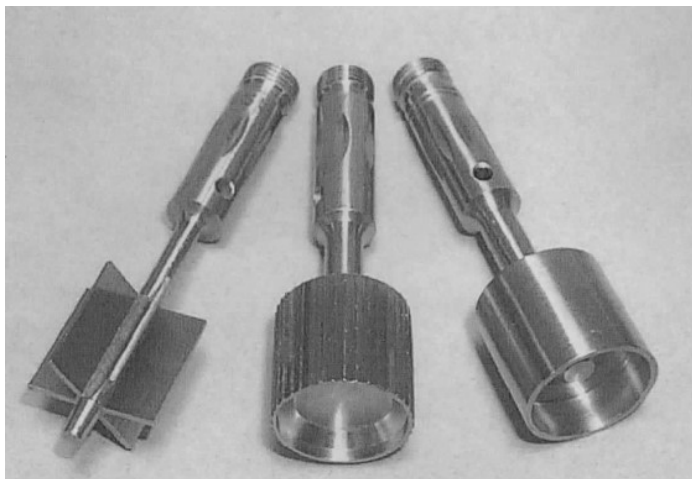
Figura 32: geometria de palhetas, cilíndrica adaptada para evitar o deslizamento e cilíndrica lisa (BARNES e NGUYEN, 2001)
