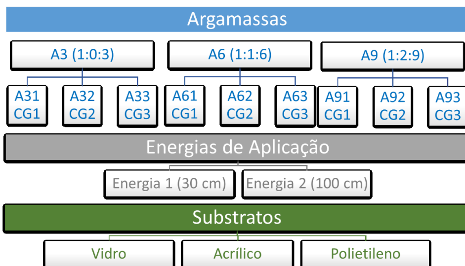
Figura 35: matriz experimental representando os fatores controláveis – Argamassas (A), Composições Granulométricas (CG), energias de aplicação e substratos de diferentes tensões superficiais
