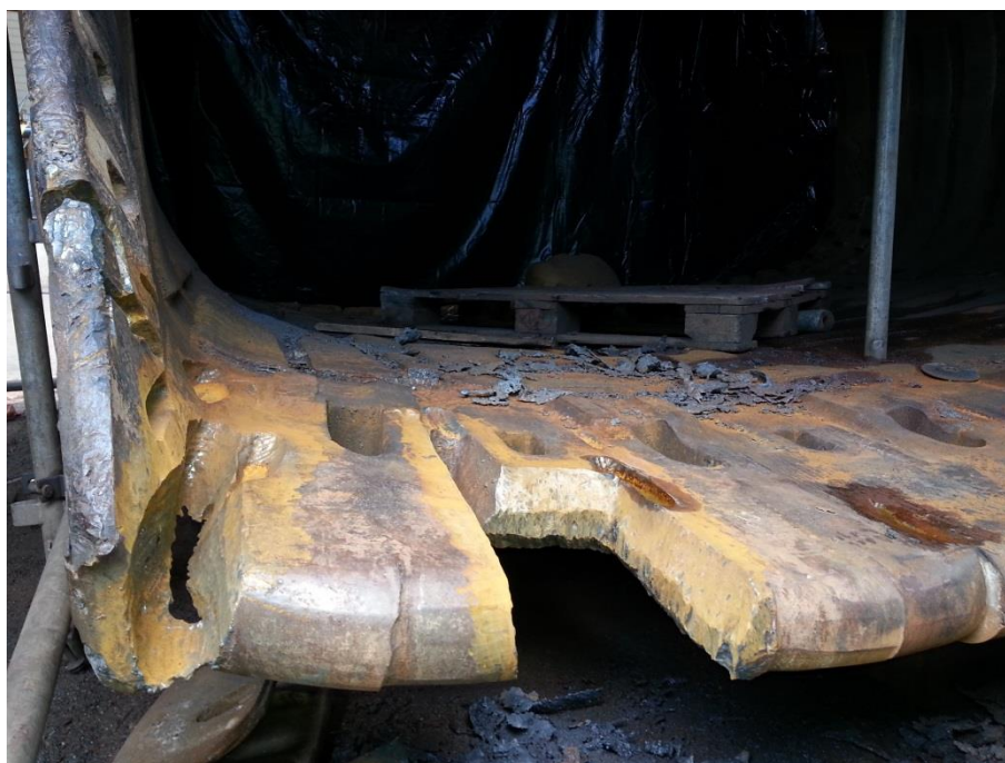
Figura 35 - Caçamba danificada devido a choque com matico encoberto por material fino.
