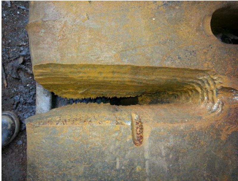
Figura 36 - Formato de danos à caçamba de equipamentos de carregamento em decorrência de choque com matacos na mina.
