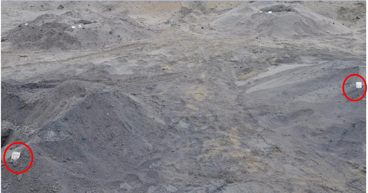
Figura 13 – Banco perfurado na mina de estudo mostrando a diferença entre as profundidades de furos em uma mesma bancada com topo na mesma cota O furo da esquerda tem 17 m e o da direita 14 m.
