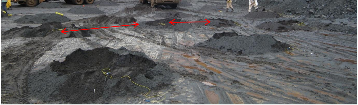
Figura 10 - Foto retirada em campo, na mina de estudo, mostrando que os espaçamentos são irregulares, contrariando as diretrizes teóricas e o plano de fogo estabelecido.
