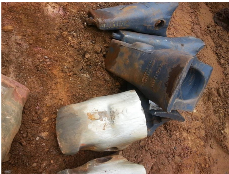
Figura 38 - Comparação entre unha nova e unha desgastada por meio de desmonte mecânico.
