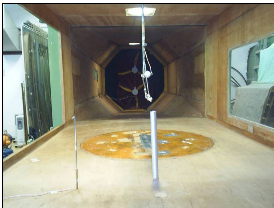
Figura 6.5 - Visão parcial da seção de trabalho. Ao fundo, os ventiladores utilizados para a geração do vento a baixas velocidades.
