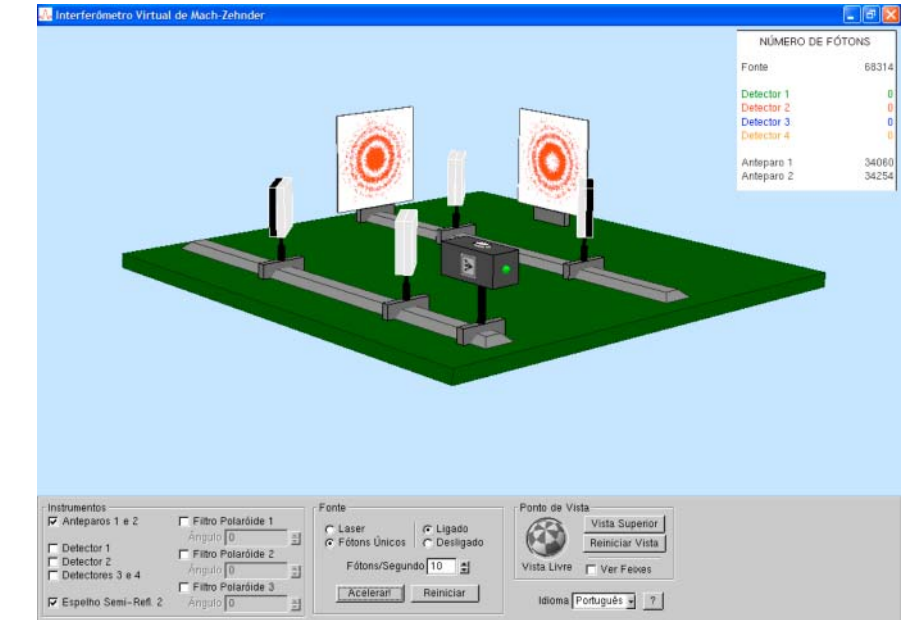
Figura 3 - Formação de franjas de interferência idênticas às obtidas com laser .
