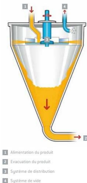
Schéma d'un désaérateur
