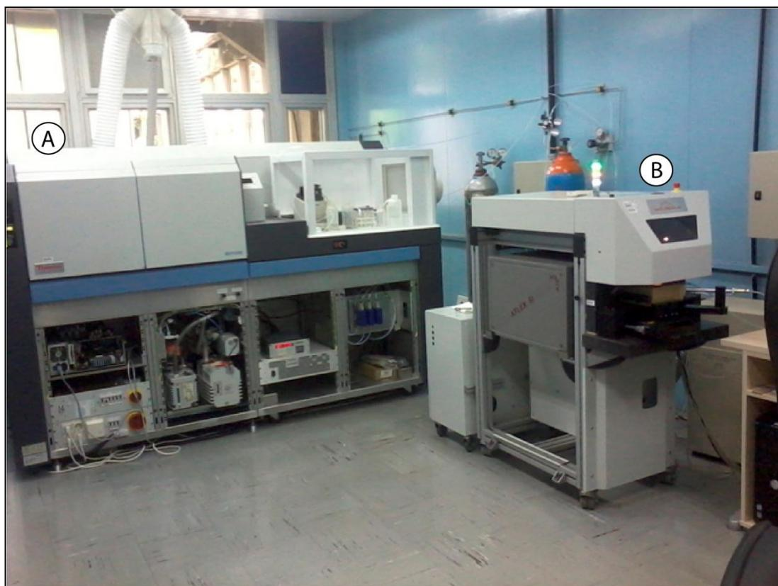
Figura 6. (A) ICP-MS e (B) microsonda a laser do Centro de Pesquisas Geocronológicas (CPGeo) da USP.
