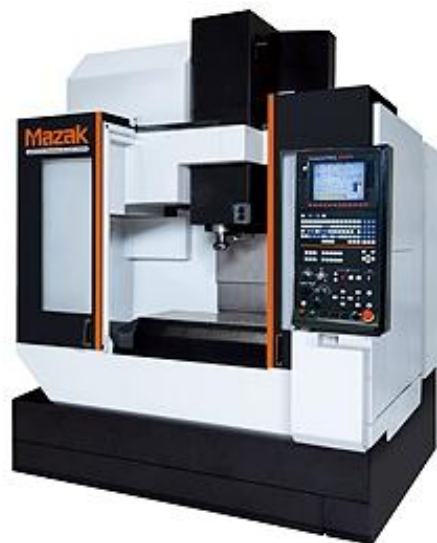
Figura 4.8 Centro de usinagem vertical utilizado nos ensaios de furação.
