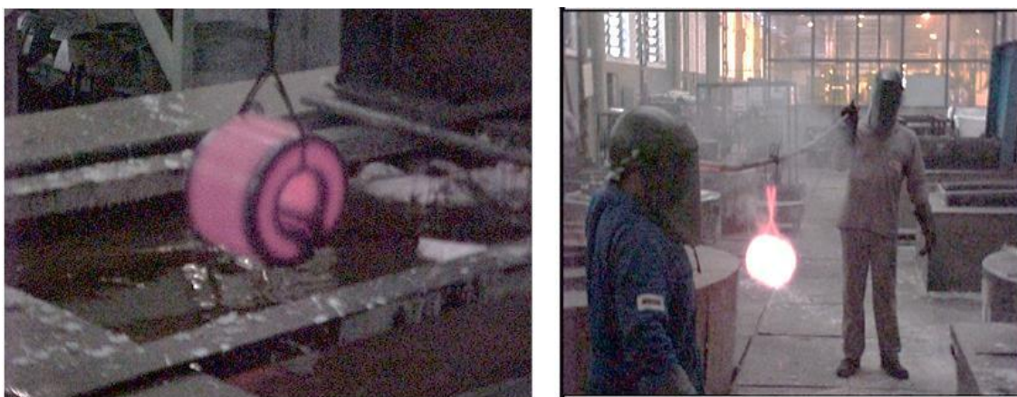
Figura 3.24 A) Peça em fase final de têmpera. B) Peça sendo movimentada (Adaptado de YOSHIDA 2007).
