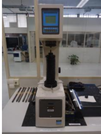
Figura 4.5 Durômetro Rockwell para realização do teste de indentação.
