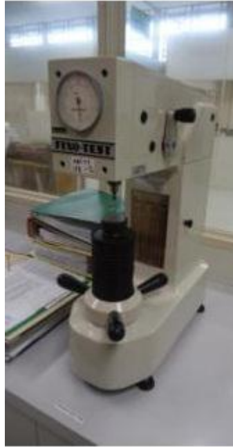
Figura 4.9 Equipamento para teste de dureza Brinell.
