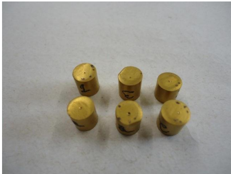
Figura 4.4 Corpos de prova para ensaio de adesão dos revestimentos.
