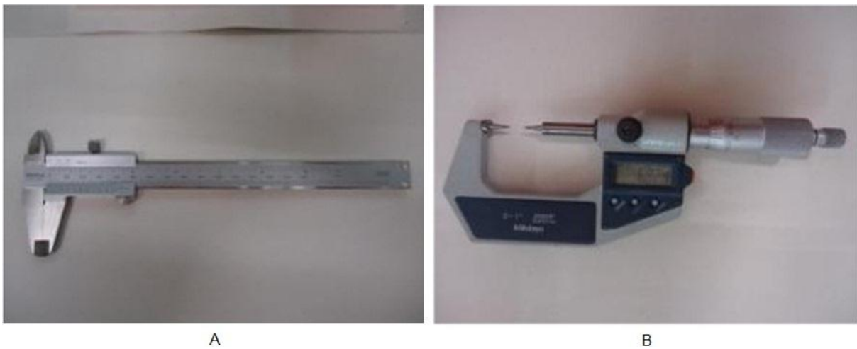
Figura 4.3 a) Paquímetro utilizado na verificação dimensional. b) Micrômetro utilizado na verificação dimensional.
