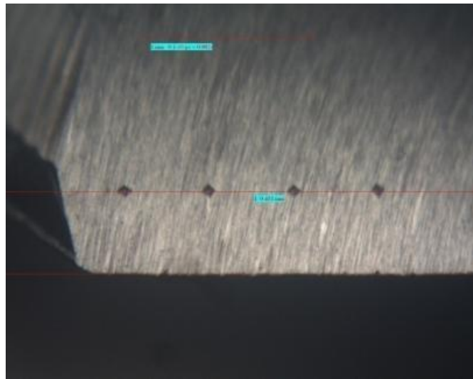
Figura 4.11 Imagem para a verificação do desgaste de flanco das amostras nos testes de furação.
