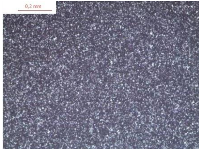
Figura 5.9 Material AISI M2 como recebido em corte transversal. Aumento 100x. Ataque Nital 10%. Tempo de ataque 60s.
