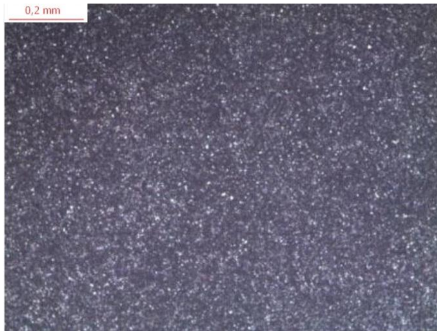
Figura 5.1 Corte transversal do aço Z2 na condição recozido. Aumento de 100x. Ataque Nital 10%. Tempo de ataque 60s.
