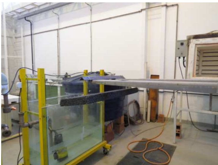
Figura 77: substituição da placa colmatada pela do primeiro ensaio
