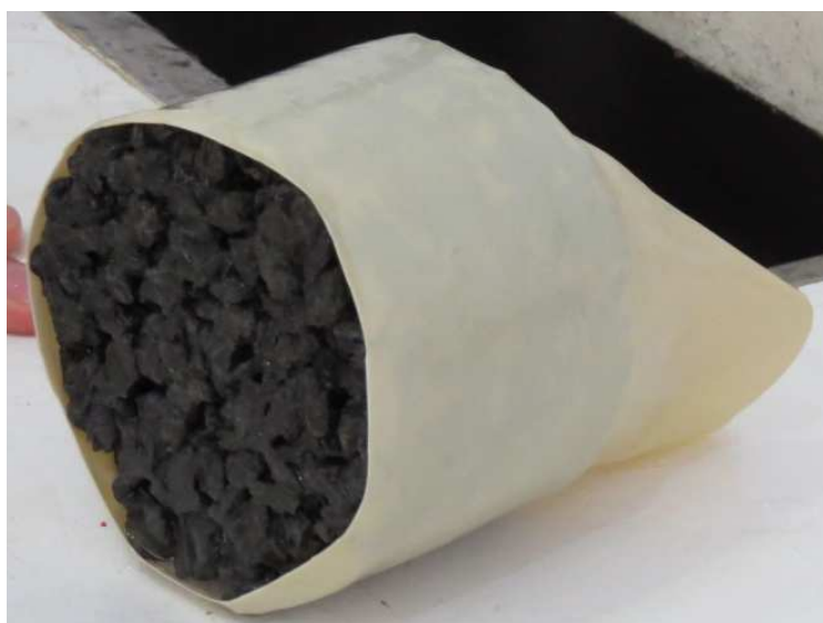
Figura 44: corpo de prova encamisado com uma membrana látex
