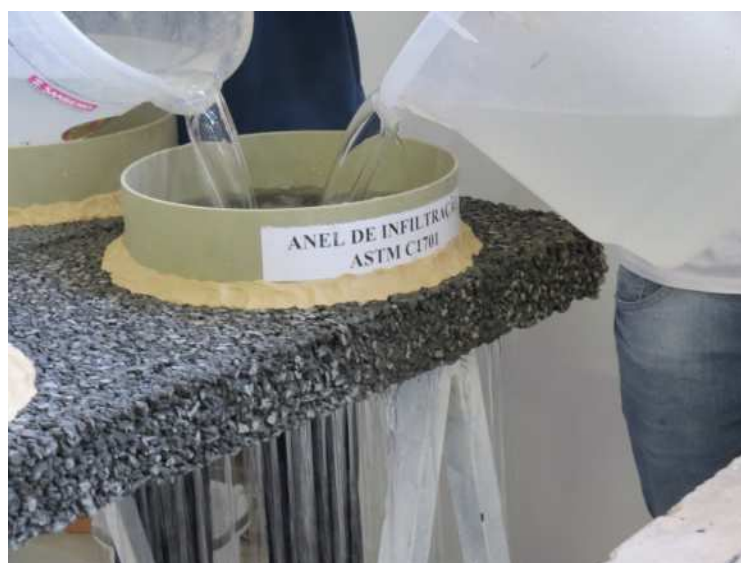
Figura 40: realização do ensaio de taxa de infiltração de água em placa de concreto permeável da Etapa 2
