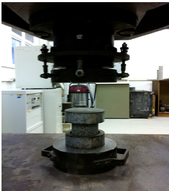
Figura 53: ensaio de resistência à compressão axial dos corpos de prova das placas de concreto permeável
