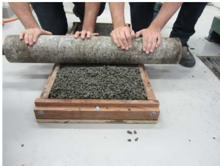
Figura 21: compactação realizada com rolo de aço adaptado
