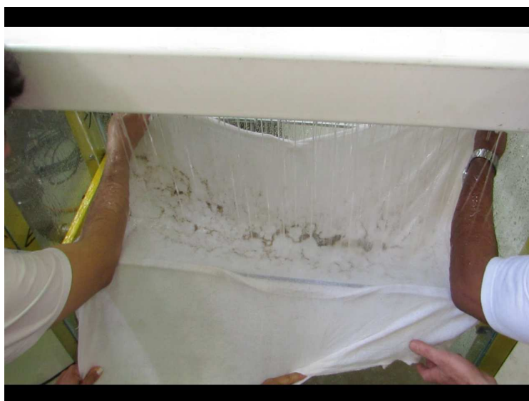
Figura 71: teste da execução do ensaio de colmatação em placa
