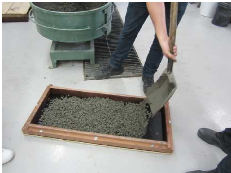
Figura 20: mistura de concreto permeável depositada na fôrma com auxílio de pá
