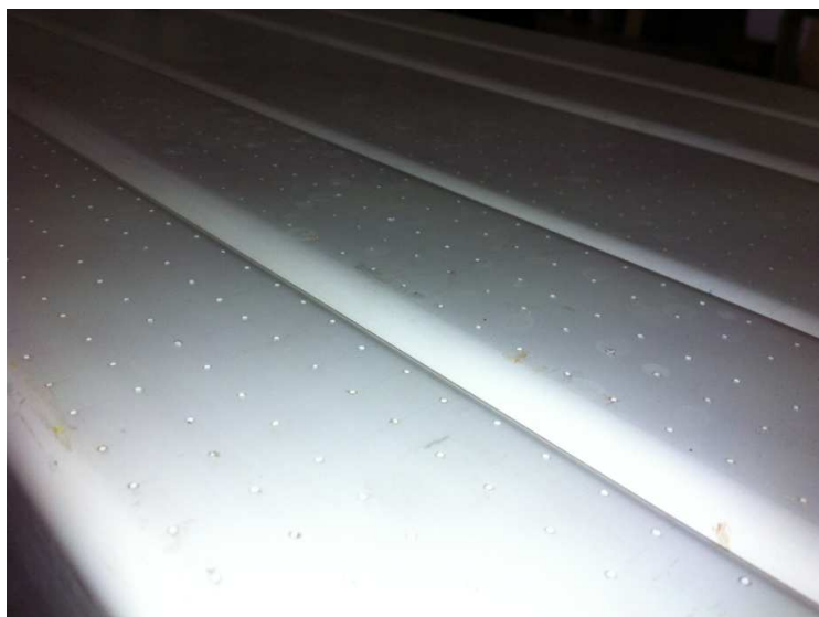
Figura 63: conjunto de condutores com furação dos orifícios para simulação de chuva natural
