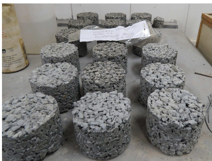
Figura 50: corpos de prova extraídos das placas de concreto permeável
