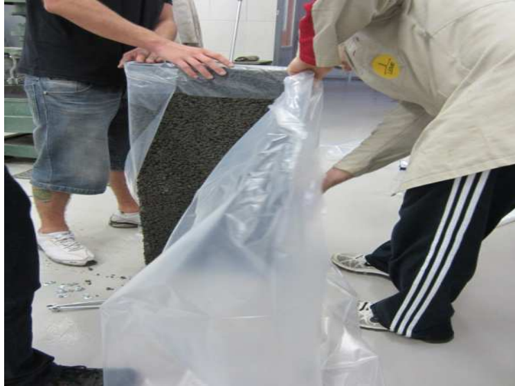
Figura 23: protótipo de concreto permeável embalado em filme plástico de polietileno
