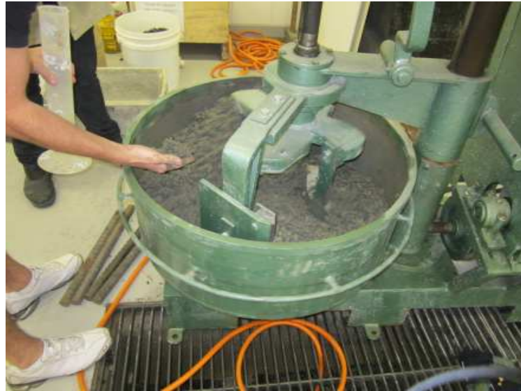
Figura 19: avaliação tátil da mistura de concreto permeável pelo operador da betoneira
