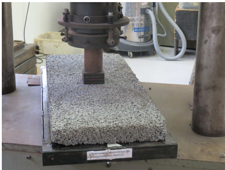
Figura 38: realização de ensaio de flexão em placa de concreto permeável da Etapa 2
