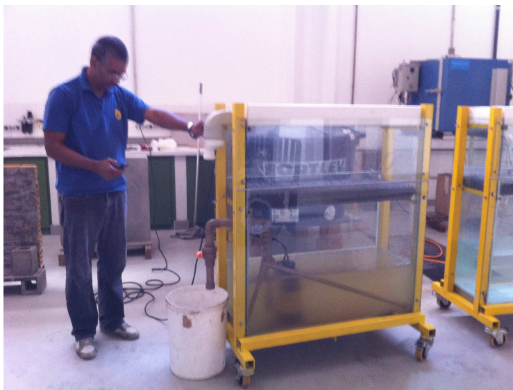
Figura 74: medições do tempo de escoamento e do volume de água retirado do reservatório
