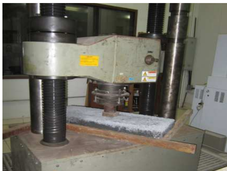
Figura 25: ensaio de flexão em protótipo de concreto permeável
