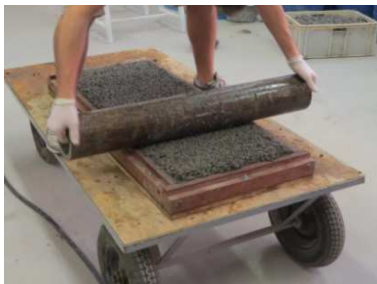
Figura 34: compactação do material na fôrma com rolo de aço
