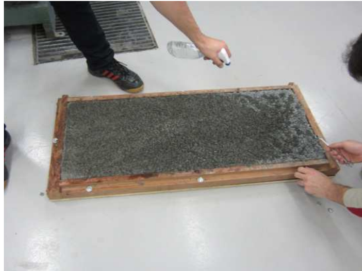
Figura 22: placa de concreto permeável borrifada com água para sua cura
