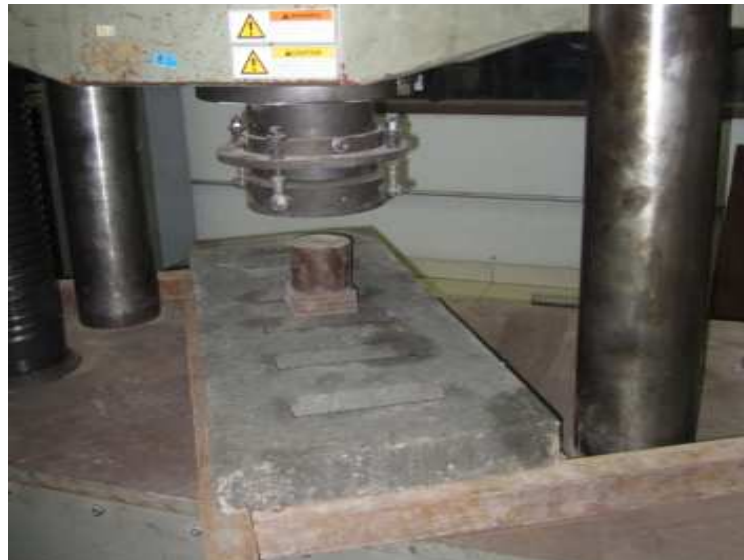
Figura 26: ensaio de flexão em grelha de concreto convencional fornecida pelo DEP
