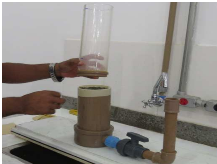
Figura 45: introdução do corpo de prova encamisado no equipamento com inversão da membrana látex pela parte externa do tubo de PVC
