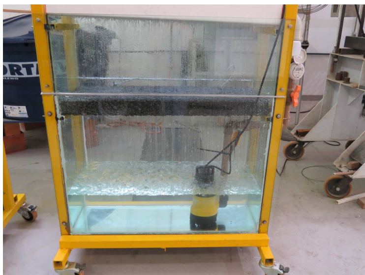
Figura 65: ensaio de permeabilidade em placa no Dispositivo 1
