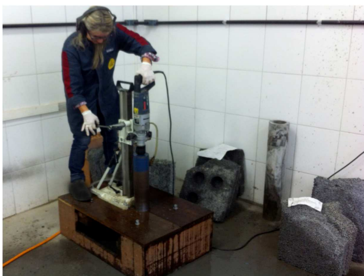
Figura 52: aparato para extração dos corpos de prova das placas de concreto permeável
