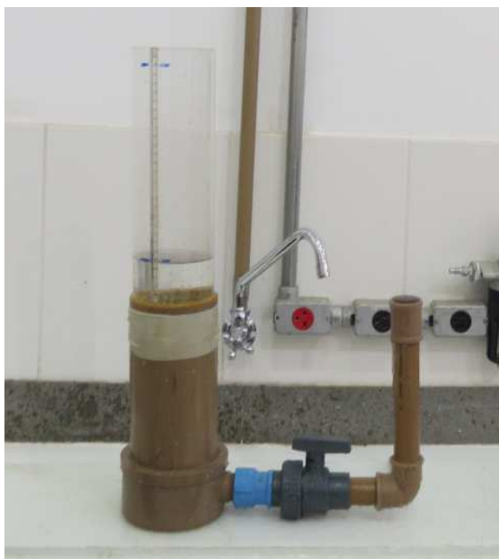
Figura 43: equipamento utilizado para ensaio de permeabilidade (baseado em NEITHALATH et al., 2003)
