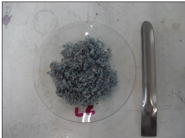
Figura 3.1: Resíduo de couro curtido ao cromo utilizado nos experimentos de adsorção
