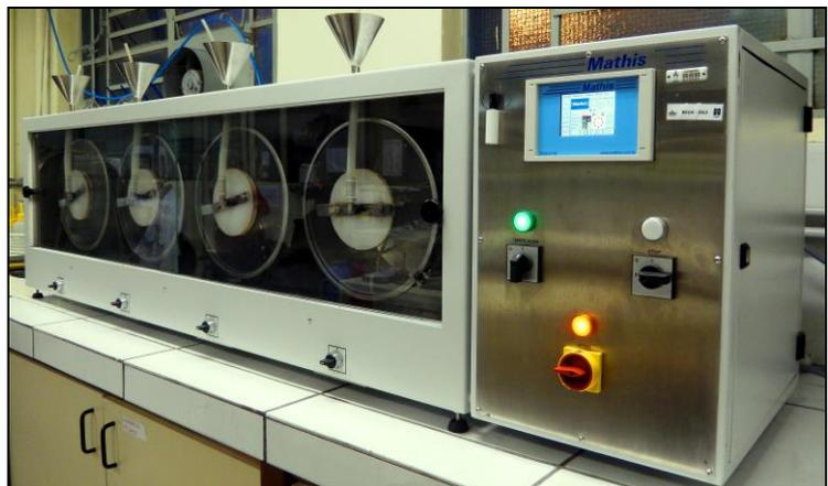
Figura 3.4: Fulões: (a) fulão em escala piloto para teste de tingimento e coleta de efluentes de tingimento e (b) fulão em escala laboratorial para ensaios de adsorção
