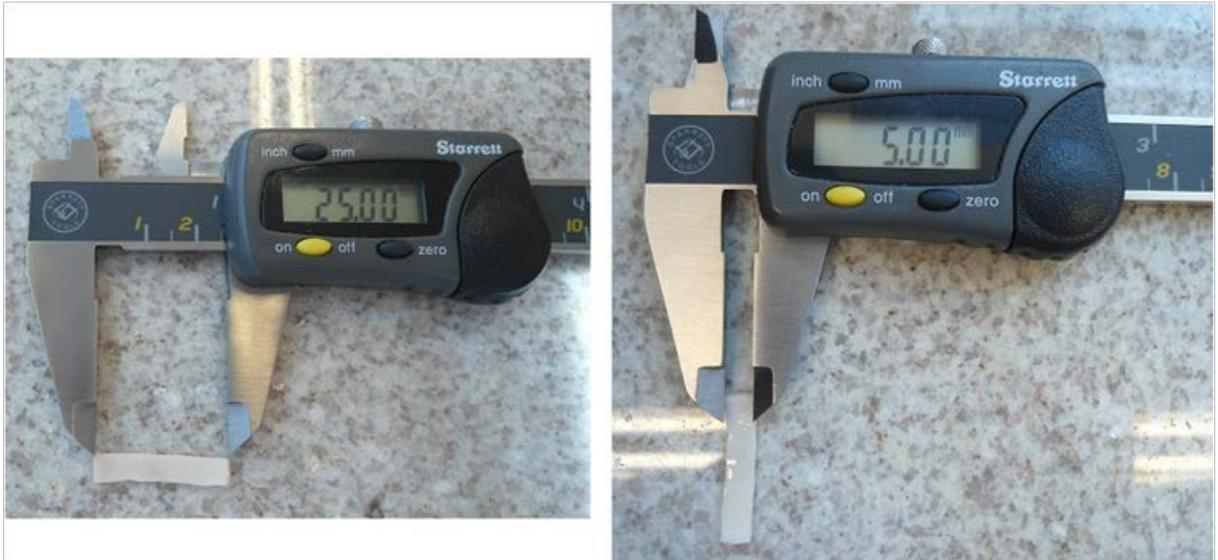
Figura 6.12 – Dimensões da artéria no ensaio final.
