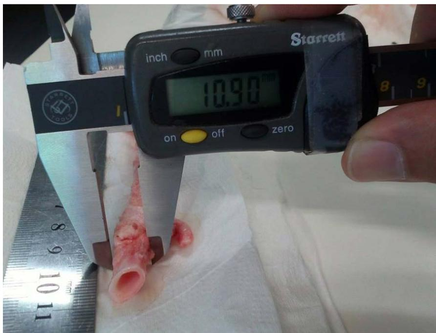
Figura 6.6 – Medição do diâmetro utilizando um paquímetro digital.
