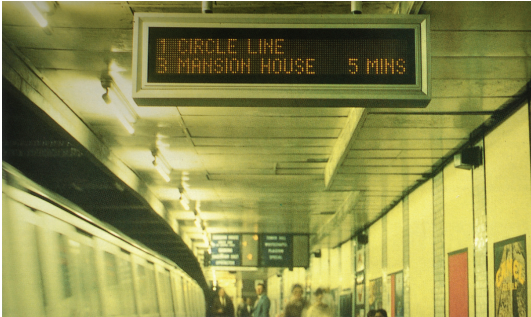
Figura 05 – painel de LED para sinalização no metrô de Londres, anos 1980. Fonte: BLACKWELL, 1998, p. 139.
