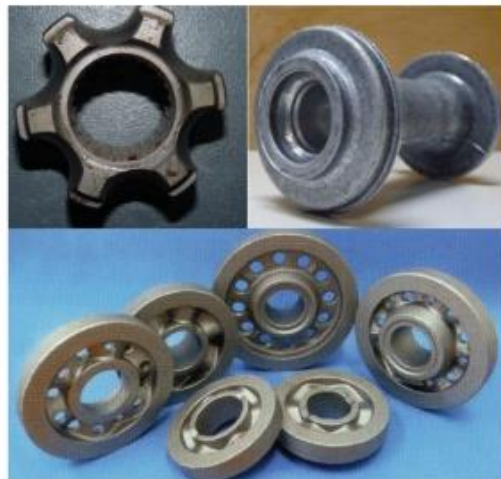
Figura 1: Exemplos de peças típicas que podem ser forjadas pelo processo proposto, a partir de billets tubulares.
