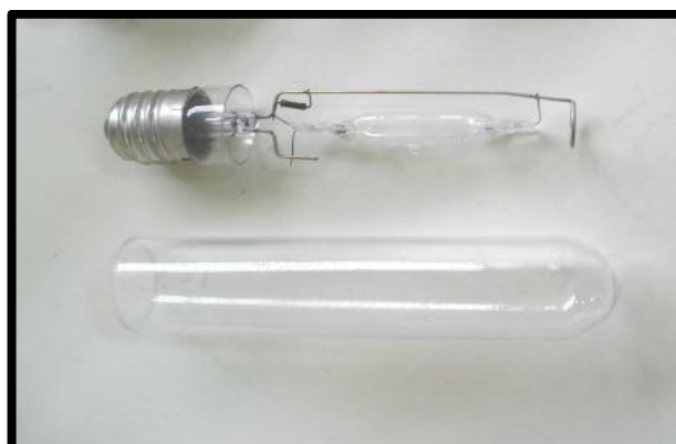
Figura 8: Tubo de quartzo e Lâmpada de vapor de mercúrio, de 250 W de potência.
