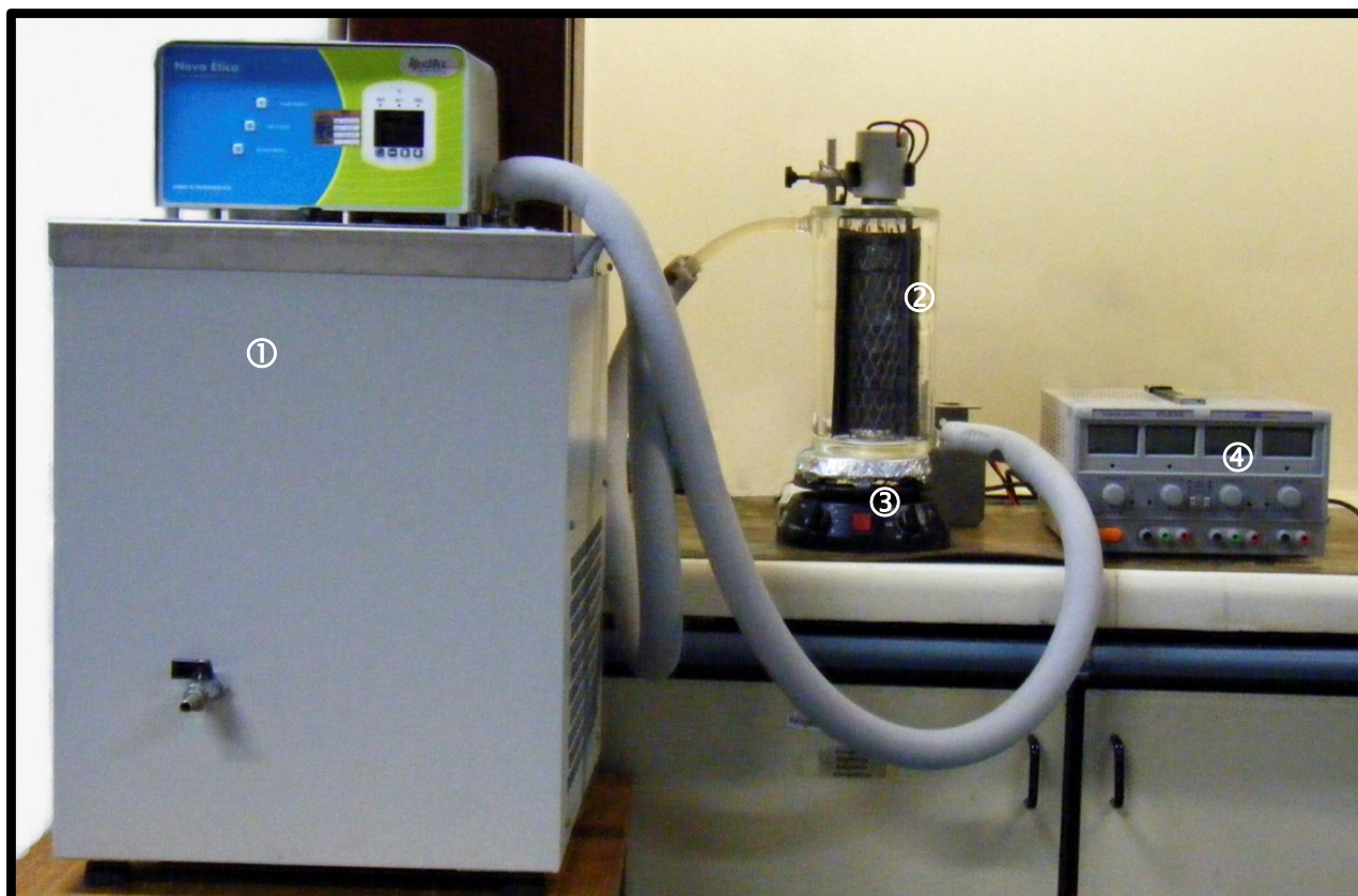
Figura 5: Aparato experimental utilizados nos experimentos de EL e FEO. Sendo: 1) banho ultratermostático, 2) reator de vidro encamisado, 3) agitador magnético e 4) fonte de corrente.
