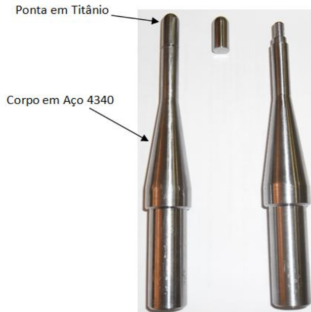
Figura 4-4: Ferramenta de estampagem incremental, especialmente desenvolvida.
