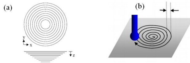
Figura 2-6: (a) Trajetória com incrementos graduais em Z; (b) Trajetória helicoidal [37].
