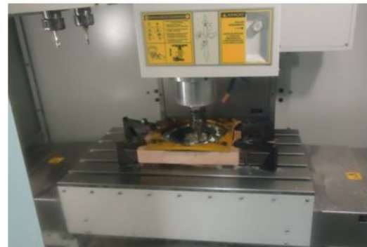
Figura 4-6: Estampagem Incremental, A) Fixação da chapa e lubrificação usada, B) Processo de estampagem.
