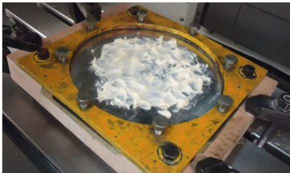
Figura 4-6: Estampagem Incremental, A) Fixação da chapa e lubrificação usada, B) Processo de estampagem.
