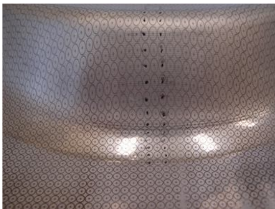
Figura 2-34: Exemplo de deformações que ocorrem em um componente estampado [45].
