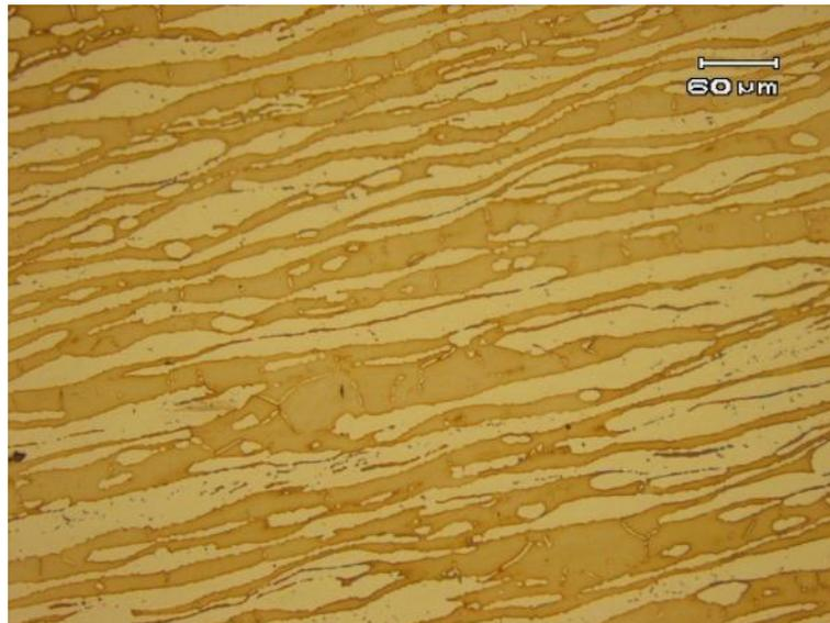
Figura 4.3 Microestrutura do metal de base revelada com ataque eletrolítico.
