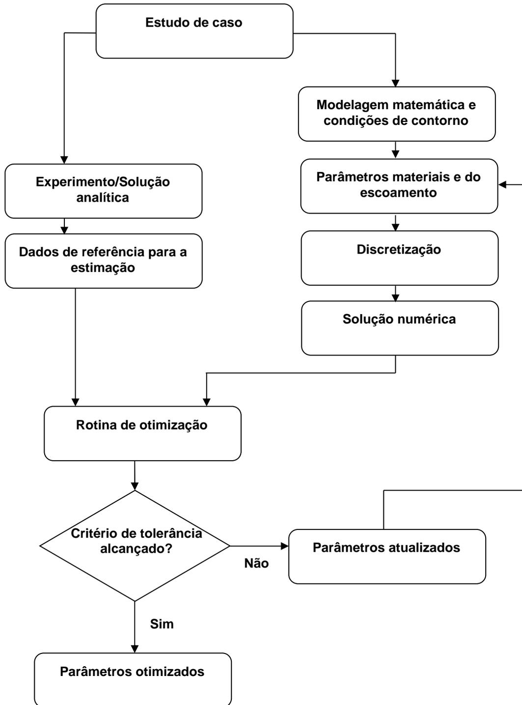
**Figura 3.8:** Fluxograma do algoritmo de estimação de parâmetros materiais.
