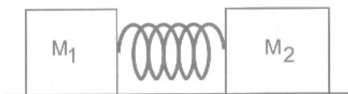
Num determinado instante, a mola é liberada e se expande, impulsionando os blocos. Depois de terem perdido contato com a mola, as massas  $M_1$  e  $M_2$  passam a deslizar com velocidades de módulos  $V_1 = 4$  m/s e  $V_2 = 2$  m/s, respectivamente.
