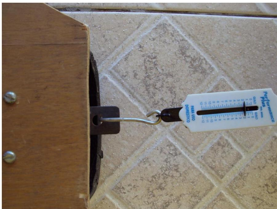
Figura 24: Obtenção da medida da força de atrito cinético, com o objeto deslizando com velocidade constante em relação à superfície.
