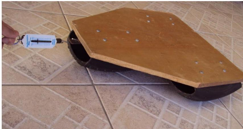
**Figura 6:** Aparato experimental para a determinação dos coeficientes de atrito entre pneus e diferentes superfícies.
