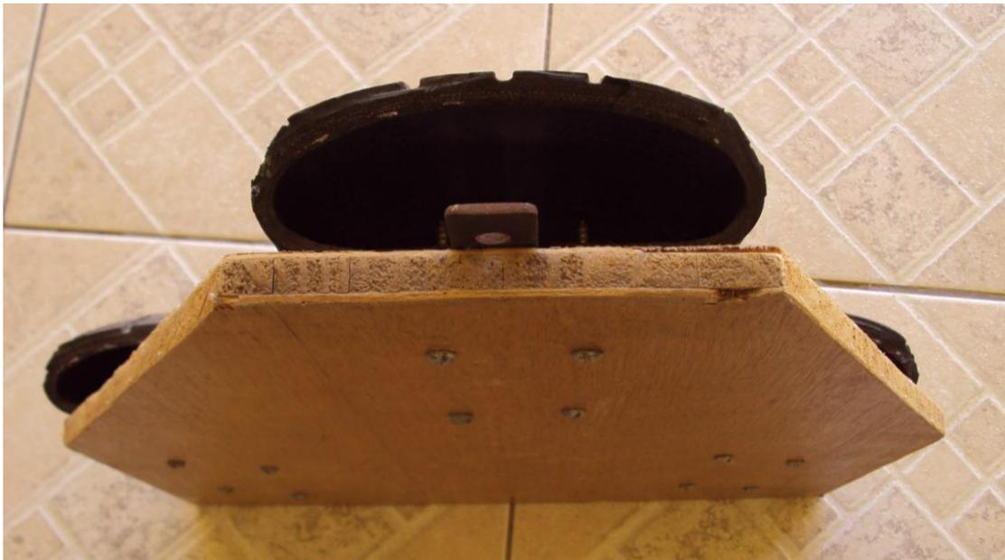
Figura 27: Vista do aparato, mostrando o gancho e os parafusos prendendo os pneus.
