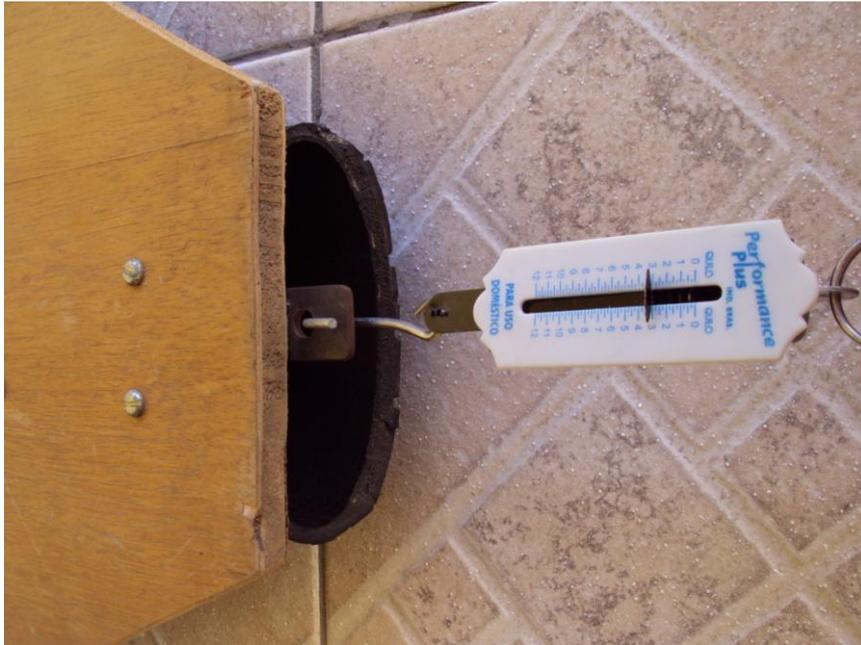
Figura 23: Obtenção da medida da força de atrito estático máxima, na iminência de derrapagem.
