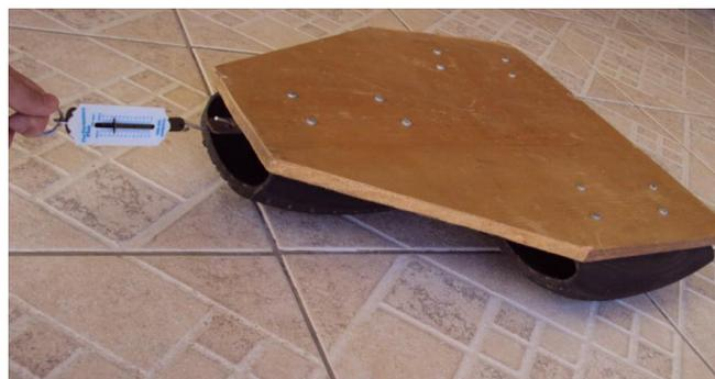
Figura 22: Tábua com pedaços de pneus sendo puxada sobre uma superfície horizontal para se obter as medidas da força de atrito.
