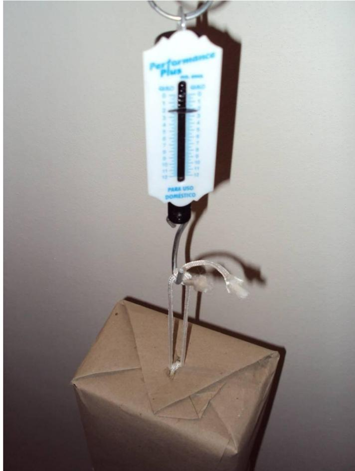
Figura 21: Bloco pendurado verticalmente para determinação da intensidade da força peso sobre o bloco.
