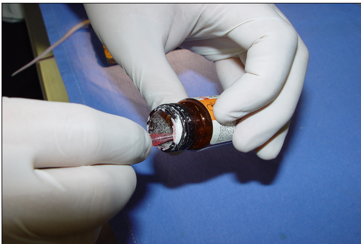
Figura 6. Preenchimento do aparelho injetor pelos cristais de DMBA
