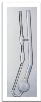
Figura 1: Viscosímetro capilar de vidro
