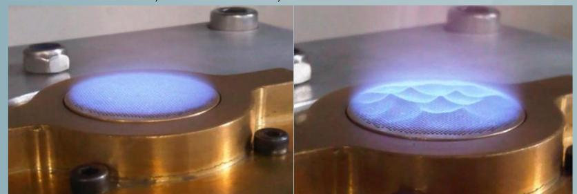
Figura 4.2 - (a) Chama plana e (b) visivelmente não plana para a razão estequiométrica de metano e ar. A perda da condição plana ocorre devido ao aumento da vazão dos gases reagentes
