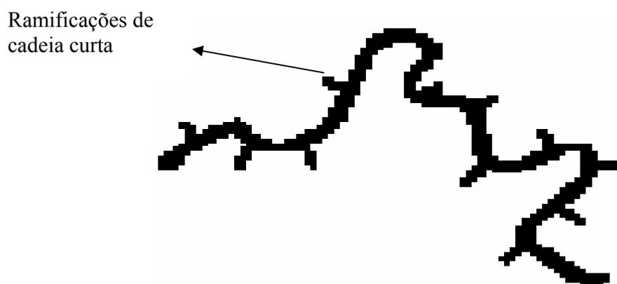
Figura 2: Tipos de ramificações do Polietileno de Linear de Baixa Densidade (PELBD).<sup>(2)</sup>
