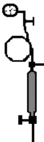
Figura 10. Pipeta de adição acoplada ao reator para introdução de reagentes.
