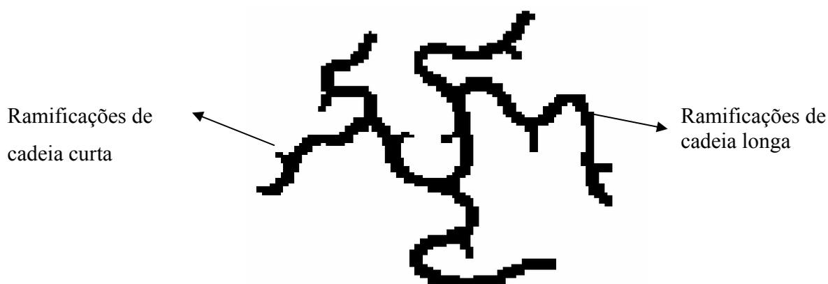
Figura 3: Tipos de ramificações do Polietileno de baixa densidade (PEBD).<sup>(2)</sup>
