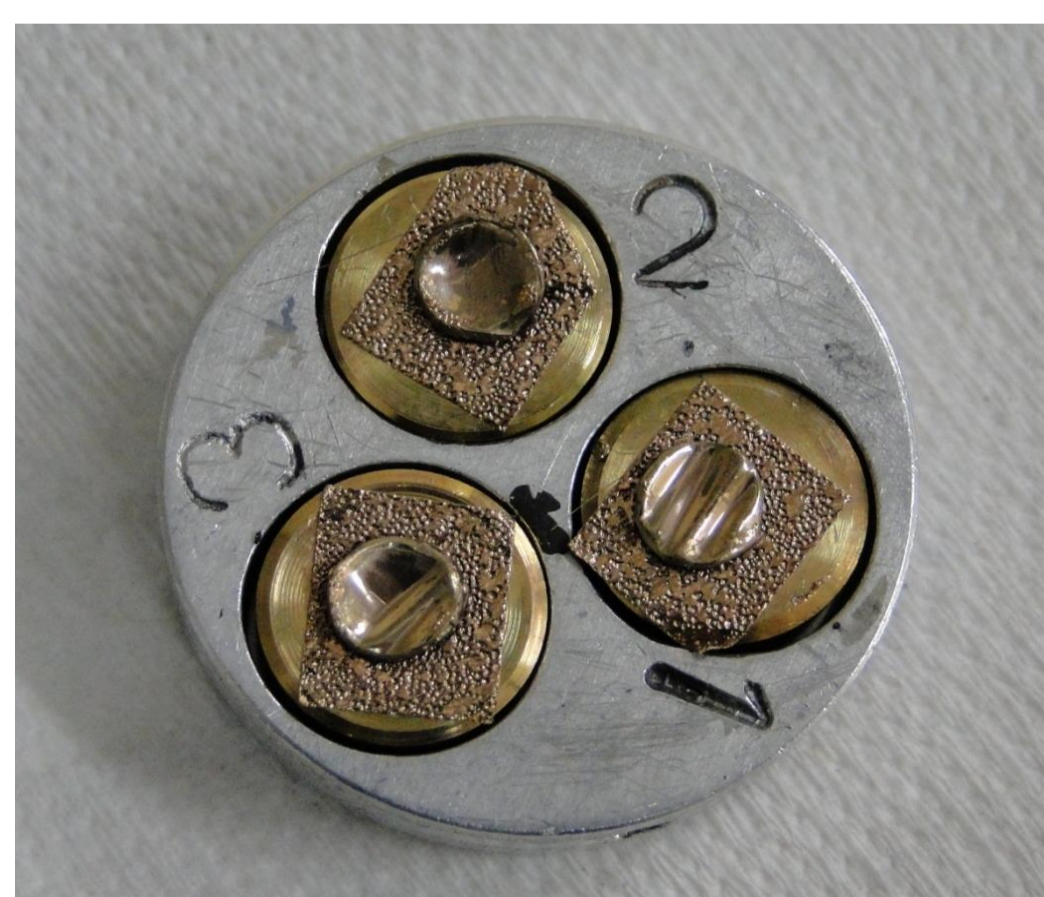
Figura 3: Imagem das córneas de equinos metalizadas para realização da Microscopia Eletrônica de Varredura.
