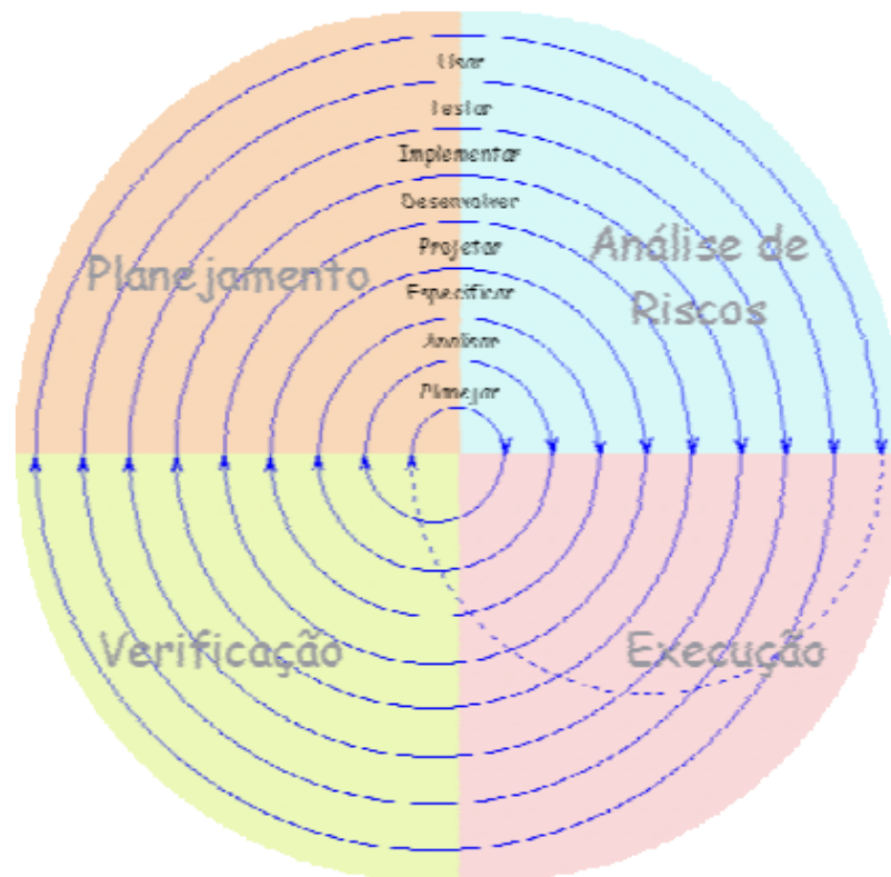
Figura 2.2 – Diagrama do modelo em espiral
