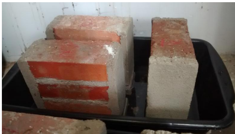
Figura 19 – Saturação dos prismas em bacia estanque
