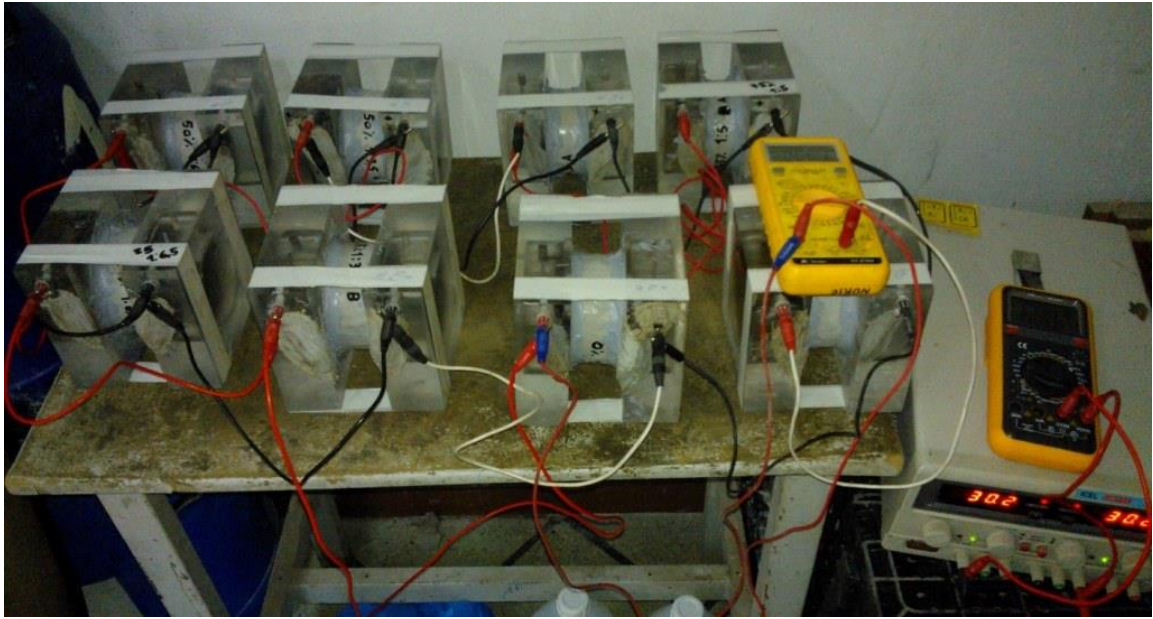
Figura 16 – Ensaio de penetração de cloretos em andamento
