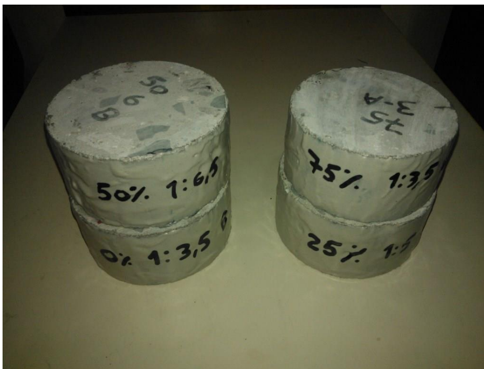
Figura 14 – Fatias de concreto com resina passada e identificadas
