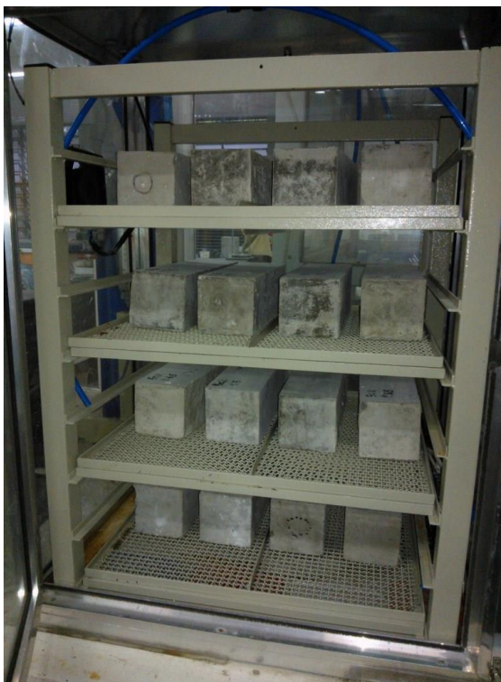
Figura 17 – Concretos dentro da câmara de carbonatação
