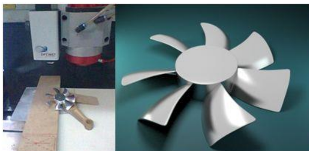
Figura 1 - Digitalização 3D e o resultado modelado em software 3D.
