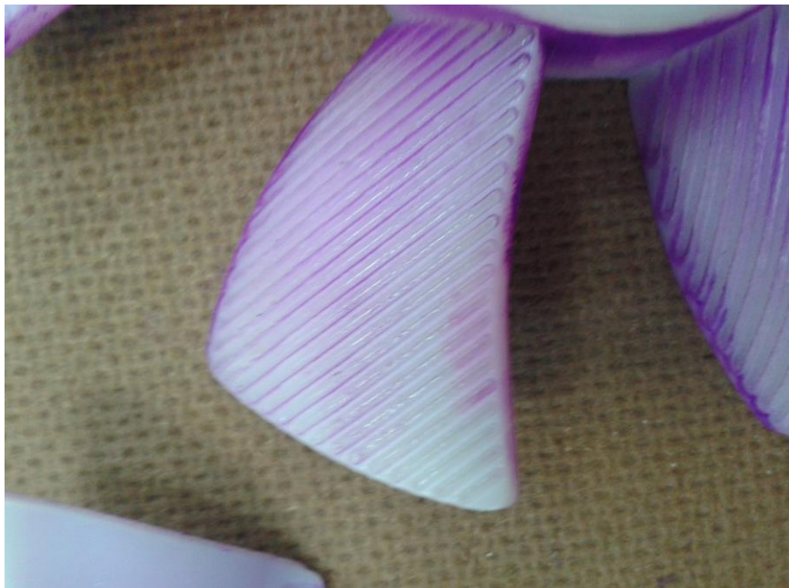
Figura 70 - Protótipo de ventoinha B.
