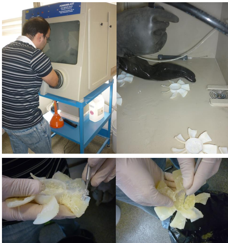
Figura 49 - Processo de retirada do material de suporte.
