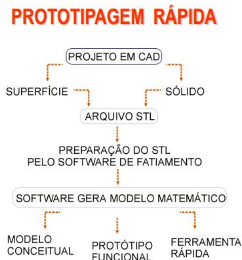
Figura 23 - Esquema de prototipação rápida.
