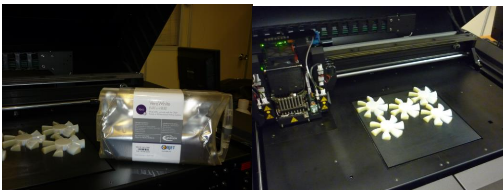
Figura 47 - Processo de impressão das ventoinhas.
