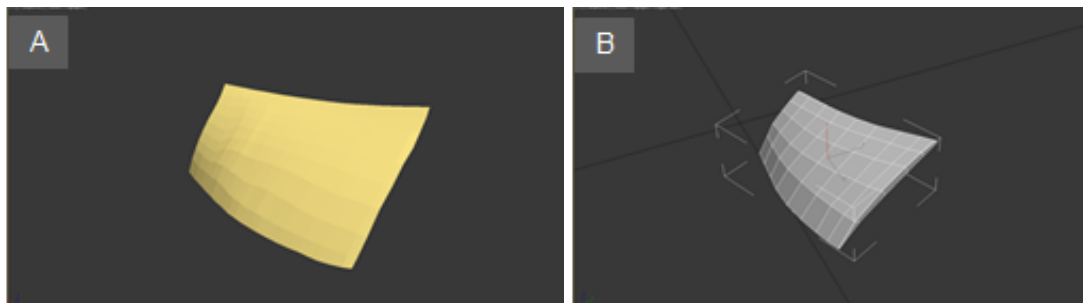
Figura 39 - (A) Malha fiel a peça escaneada. (B) Malha simplificada e mais ordenada em 3DSMax.
