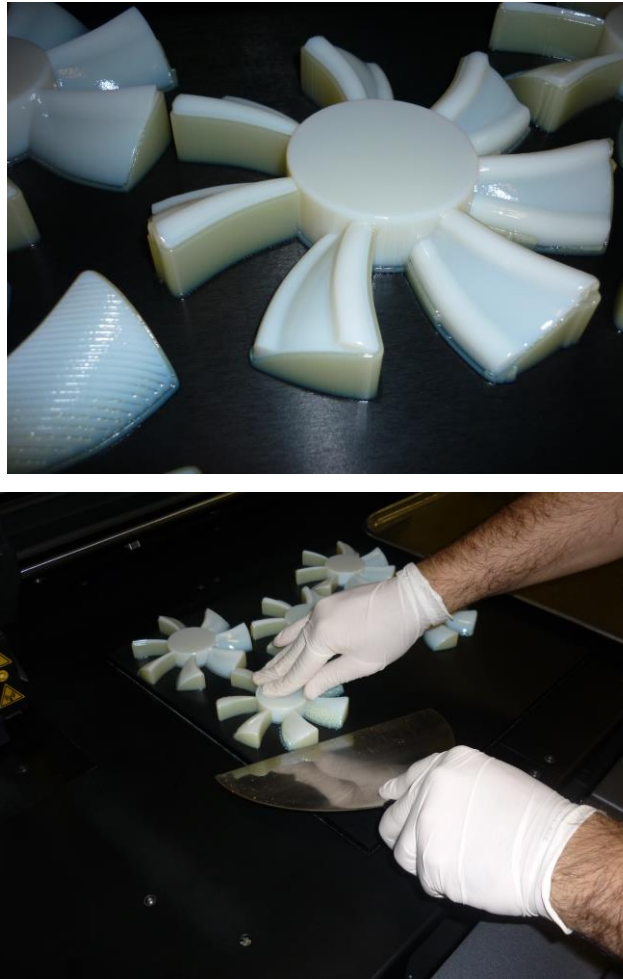
Figura 48 – Processo de impressão e de retirada da máquina.
