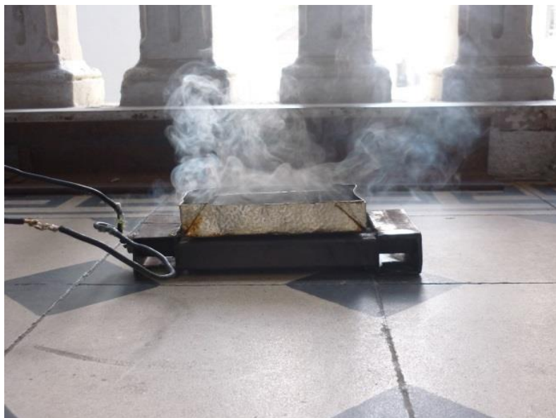
Figura 52 - Bandeja de alumínio para depositar o óleo (sistema interno do pulmão de fumaça)
