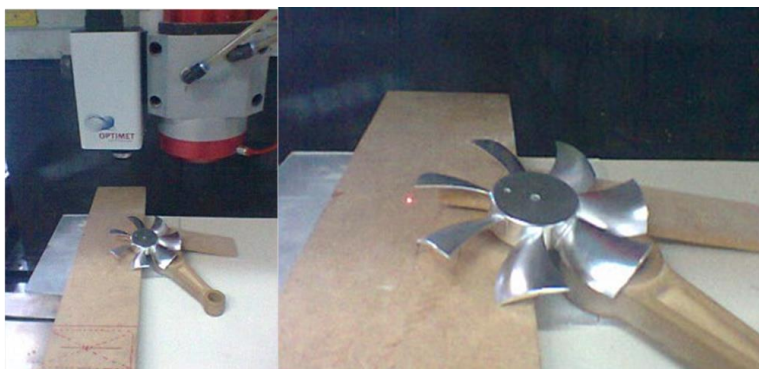
Figura 36 - Peça no LdSM da UFRGS sendo digitalizada no Scanner Tridimensional a Laser modelo Digimill 3D, em vista superior.
