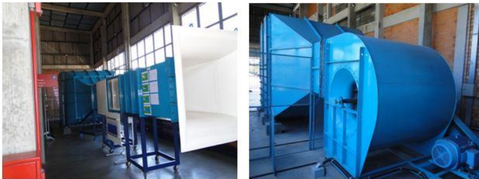
Figura 29 - Túnel aerodinâmico 1 - Monitorado para testes de perfis aerodinâmicos.
