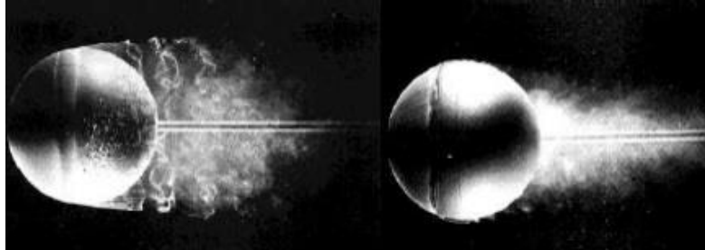
Figura 35 - Crise do arrasto durante a trajetória de uma bola texturizada em comparação com uma bola lisa.
