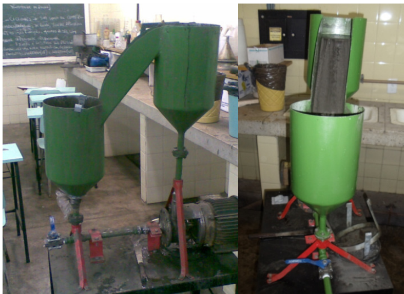
Figura 25 Equipamento separador por meio denso de Fe-Si.
