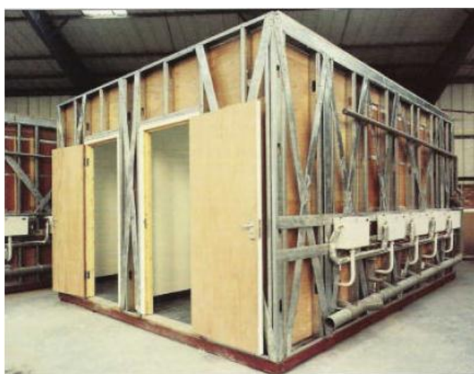
Figura 11 – Módulo de banheiro
