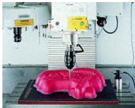
Figura 6 – Digitalização em fresadora CNC DECKEL [13]
