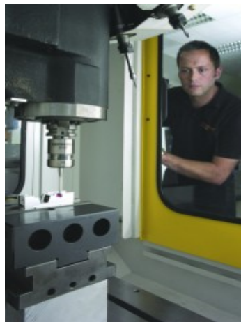
Figura 5 – Sistema Retroskan( RENISHAW) em fresadora CNC [11]
