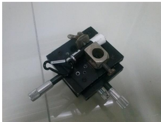
Figura 15: Laser em cima dos trasladores x,y,z
