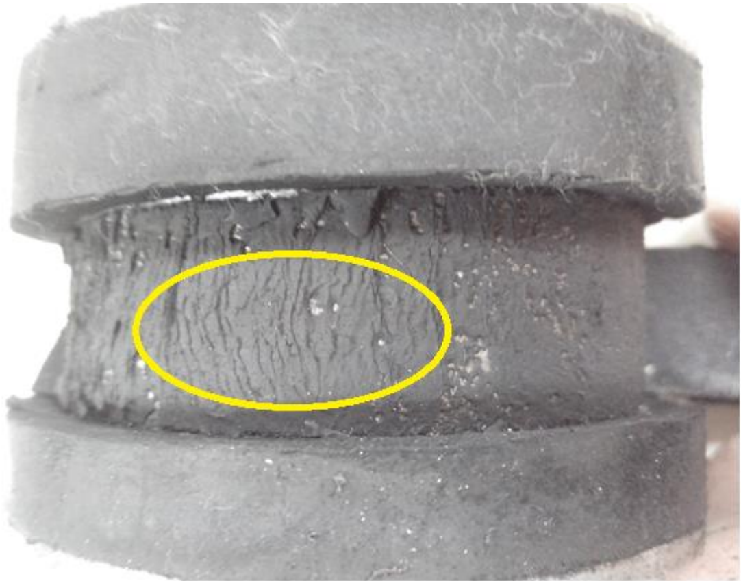
Figura 14 – Peça fosfatizada pouco metal aparente. Volume de borracha residual na peça detalhado.
