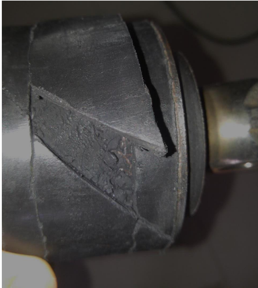
Figura 12 – Cortes para arrancamento da tira
