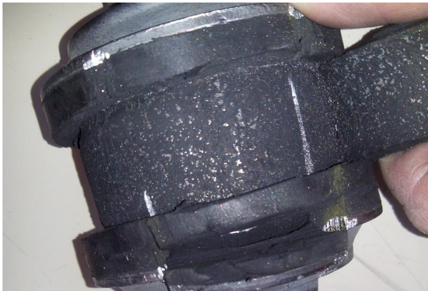
Figura 13 – Peça sem revestimento com muito metal aparente
