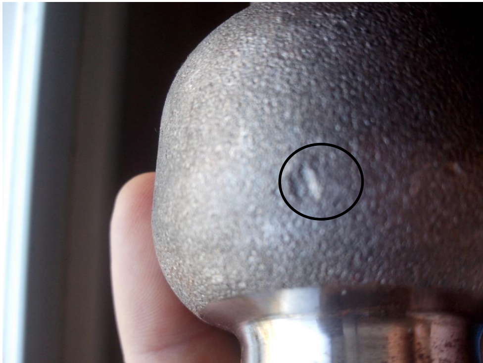
Figura 8 – Avaria em peça que pode ocasionar medição não representativa de Ra
