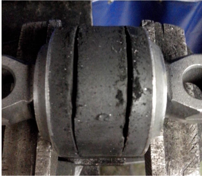
Figura 11 – Cortes longitudinais feitos para o teste de arrancamento
