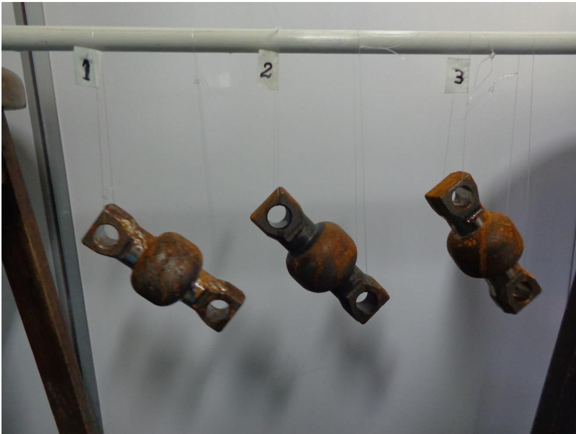
Figura 16 – Resultado do ensaio de névoa salina: peça sem revestimento (1), fosfatizada com óleo(2) e revestida com nanocerâmica (3)
