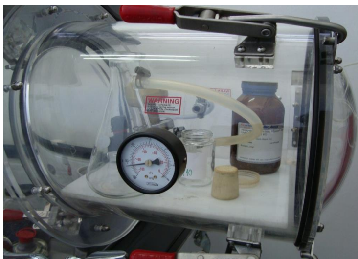
Figura 4.6 – Câmera anaeróbica – glove box –, onde o manuseio do material para evitar contaminação com oxigênio e/ou carbono.
