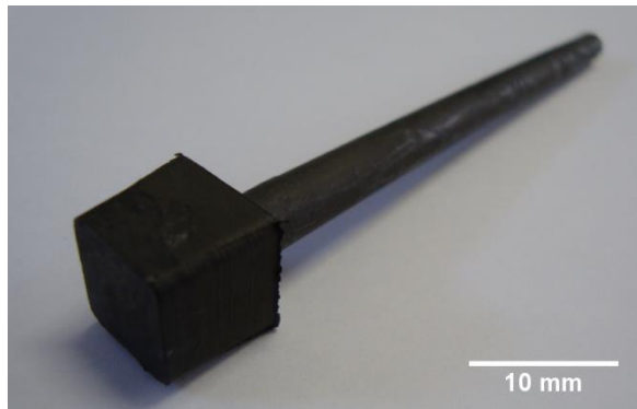
Figura 5.4 – Corpo de prova e canal de injeção.
