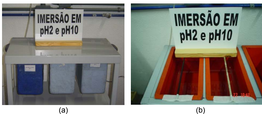
Figura 3.4 - Recipientes de imersão em pH 2 e em pH 10 (a) recipientes fechados e (b) recipientes abertos
