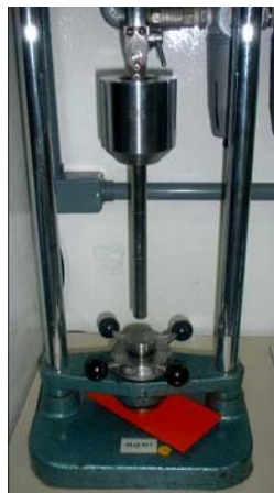
Figura 3.3 - Equipamento utilizado para teste de impacto Fonte: Elcometer
