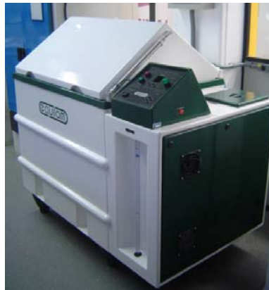
Figura 3.6 - Câmara de Umidade
