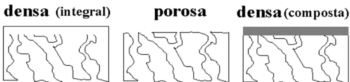
Figura 5: Ilustração da estrutura de membranas anisotrópicas (HABERT *et al*, 2006).
