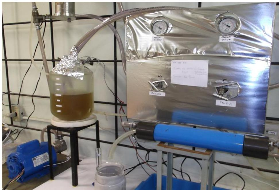
Figura 23: Foto do experimento de batelada com recirculação do caldo fermentado.
