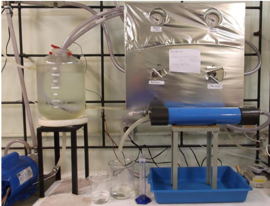
Figura 22: Foto do sistema de osmose inversa de bancada utilizado.
