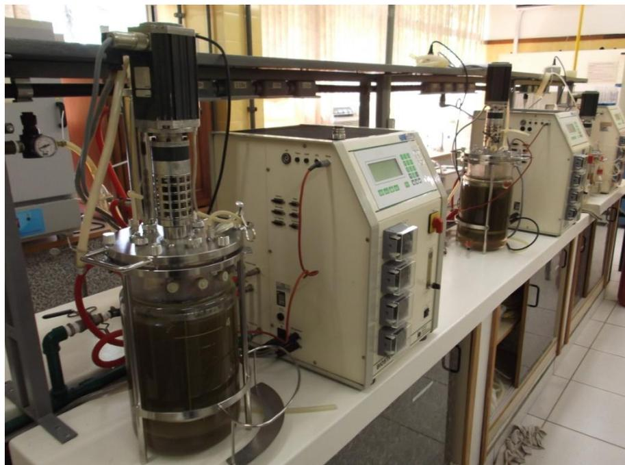
Figura 21: Foto dos biorreatores utilizados nos experimentos de fermentação.
