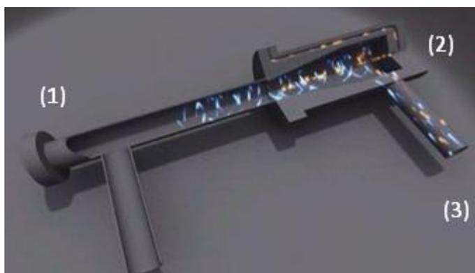
**Figura 3.3:** Funcionamento do hidrociclone. (1) *underflow*; (2) *overflow*; (3) entrada.
