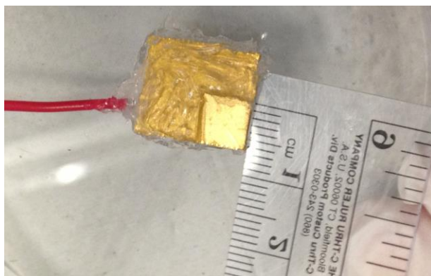
Figura 10. Eletrodo de ouro (ânodo) com parte frontal parcialmente coberta com silicone. Quadrado de 0,6 cm de lado de Au exposto.
