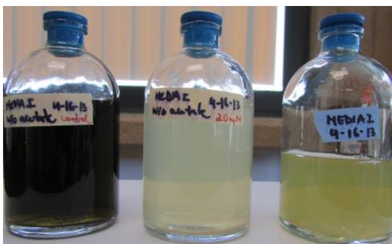
Figura 29. G. metallireducens inoculada no controle, sem fonte de carbono, em 20 mM de glicerol e no controle com acetato (esquerda para direita).
