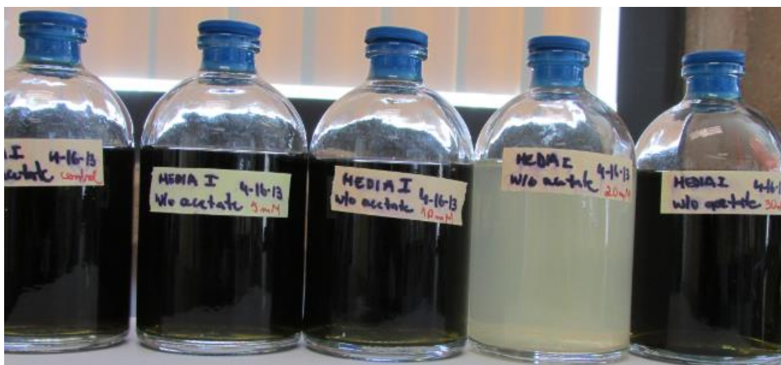
Figura 30. G. metallireducens inoculada no controle sem glicerol, 5, 10, 20 e 30 mM de glicerol (esquerda para direita). Pode-se ver o crescimento de bactérias apenas no frasco contendo 20 mM de glicerol
