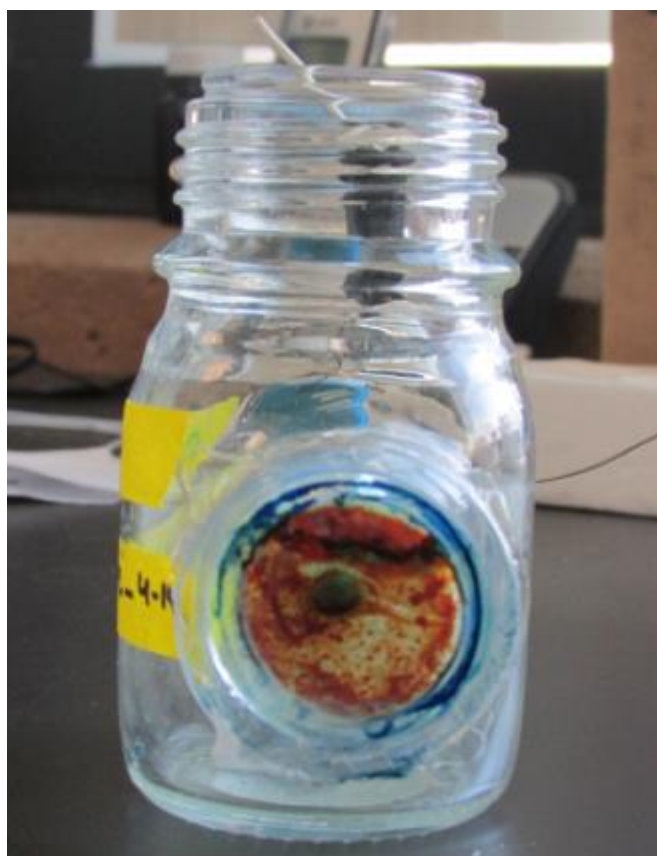
Figura 14: Entupimento da membrana semipermeável pela alta concentração de ferricianeto.
