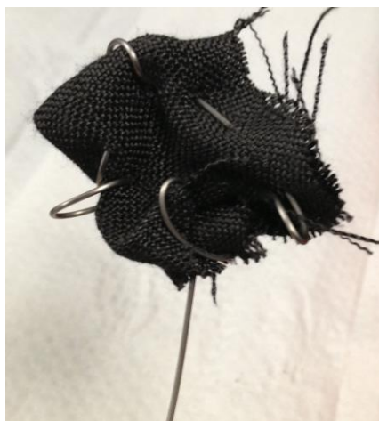
Figura 11. Cátodo de tecido de carbono costurado com fio de titânio.
